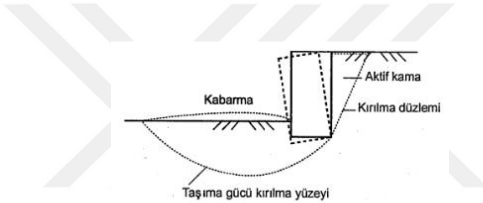
Şekil 27. Dayanma duvarlarında taşıma gücü yenilmesi (Uzuner, 2014).
