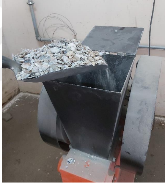
Şekil 14. Deniz kabuklarının mini konkasörde kırılması
