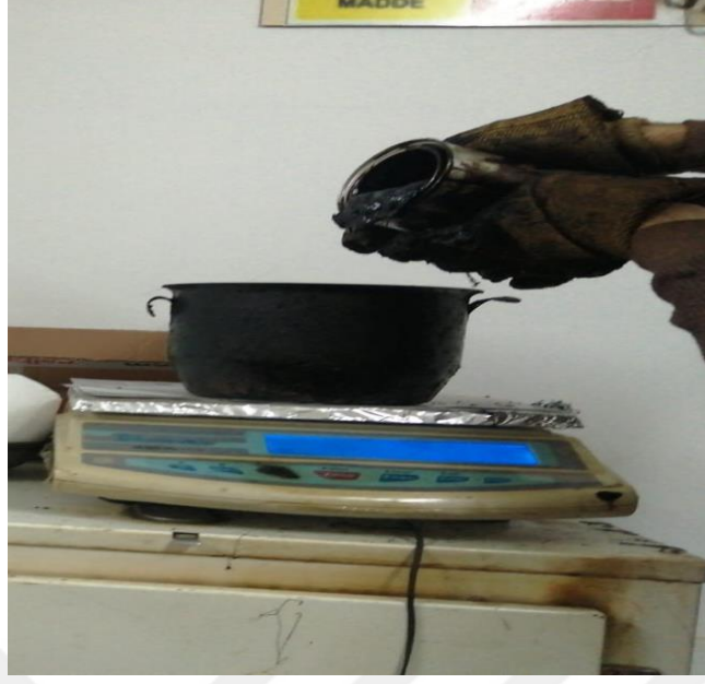
Şekil 2.3. Bitüm-lif karışımının silindirik metal teneke kutusuna konulmasından sonra tekrar kullanımı
