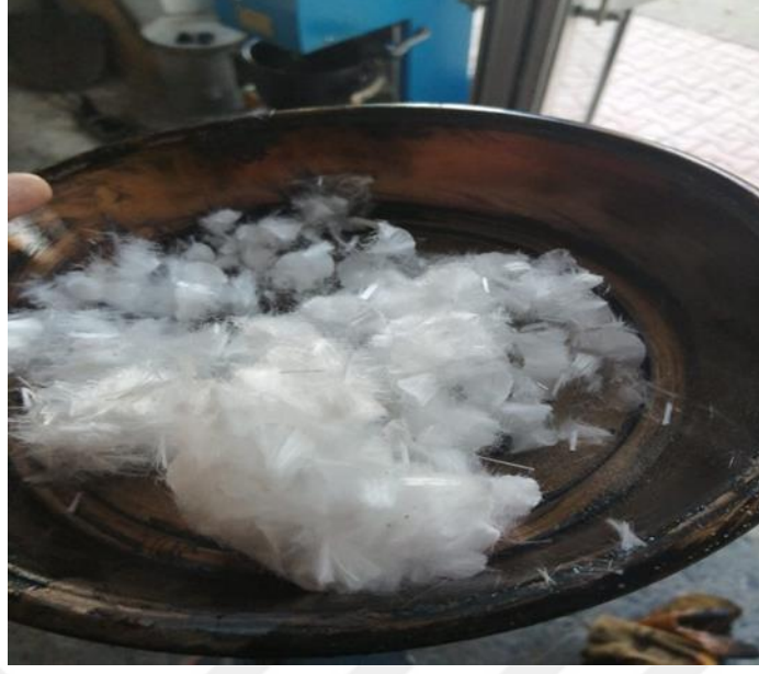
Şekil 2.1. Deneyde kullanılan polipropilen lif
