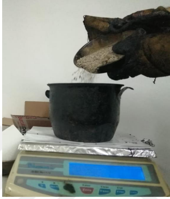
Şekil 2.5. Lifli bitüme uygun miktarda kumun eklenmesi
