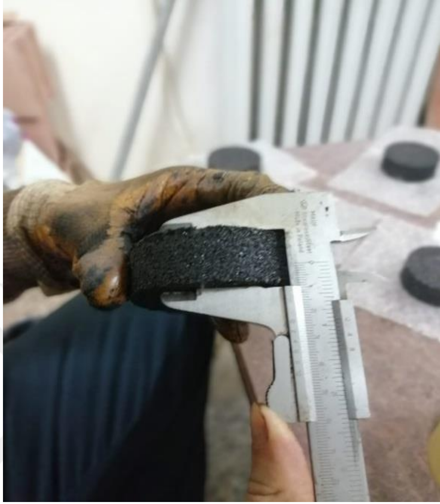
Şekil 2.8. Kumpas ile yükseklik ve yamukluk ölçümü
