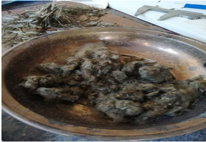
Şekil 2.2. Deneyde kullanılan bazalt lif
