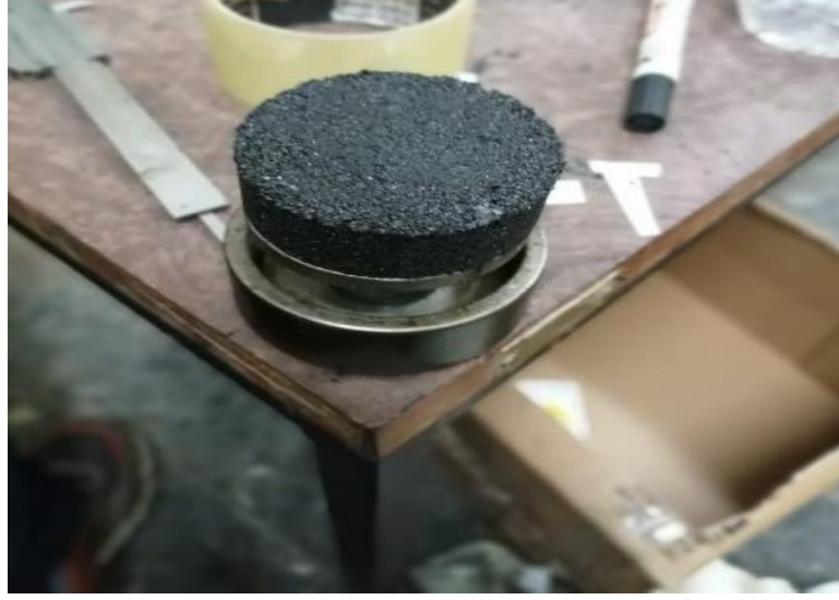
Şekil 2.6. 63,5 mm çapındaki çelik çapta sıkıştırılmış numune
