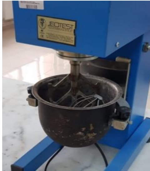
Şekil 2.4. Bitüm karıştırma mikseri
