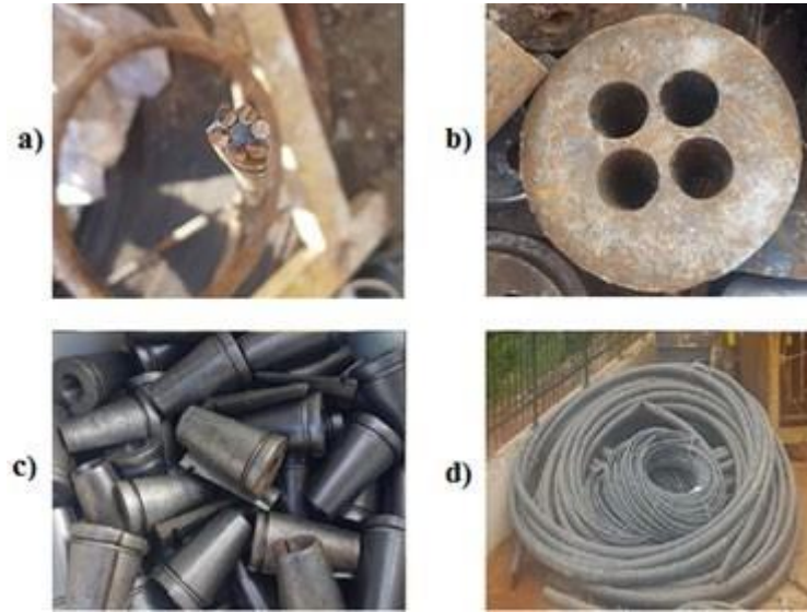
Şekil 1.10. a) Ankraj halatı, b) Ankraj başlığı, c) Ankraj kamaları, d) Muhafaza kılıfları
