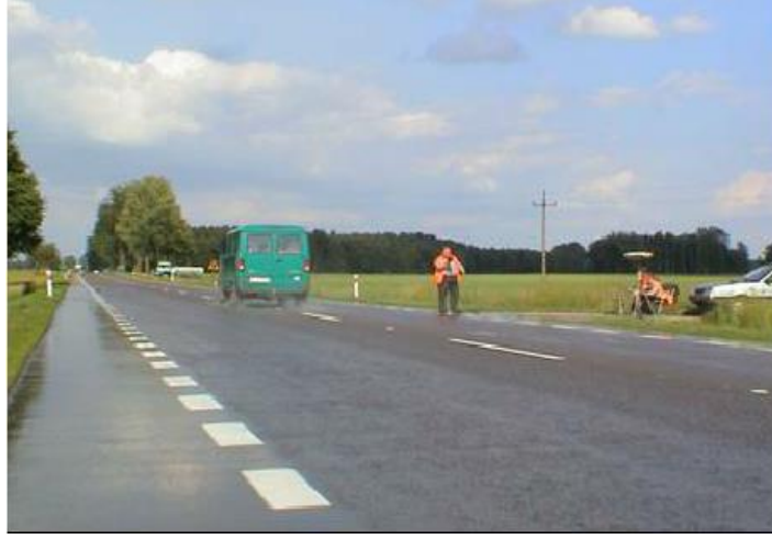
Şekil 14. Araç gürültüsü ölçümleri (CPB yöntemi) (URL-3, 2021)
