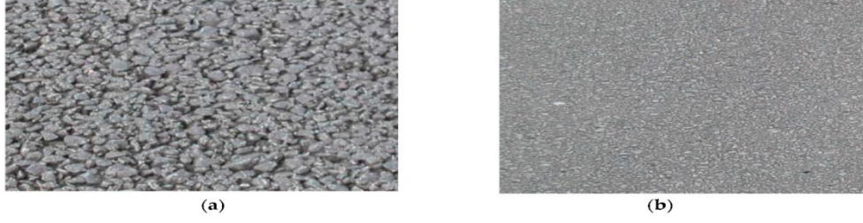
Şekil 28. (a) Gözenekli asfalt kaplama- (b) Yoğun gradasyonlu asfalt kaplama (EAPA, 2007).
