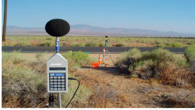
Şekil 13. Yol kenarı geçiş ölçüm cihazı (Rochat, 2012).
