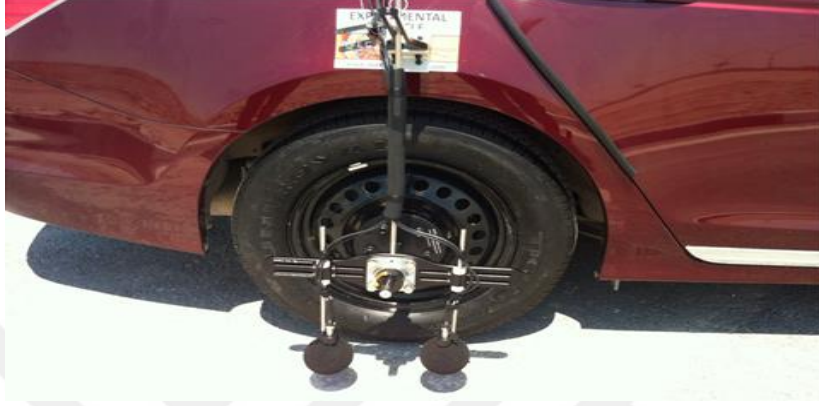
Şekil 16. OBSI test düzeneği(Ohiduzzaman vd., 2016).
