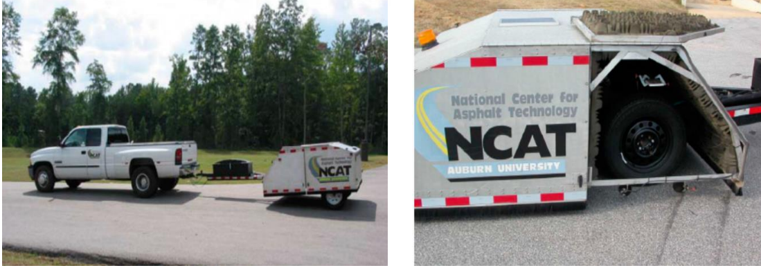
Şekil 15. Asfalt teknolojisi merkezi CPX treyler (Hanson vd, 2004)
