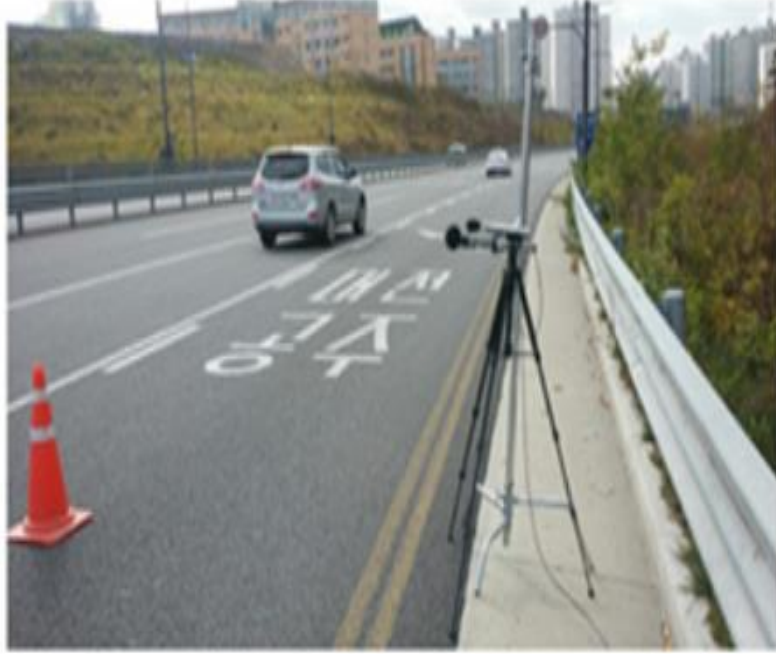
Şekil 34. Yol kenarındaki gürültü seviyesinin ölçülmesi (Yoo vd., 2020).
