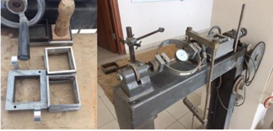
Şekil 2.6. Kesme kutusu deneyinde kullanılan deney aletleri
