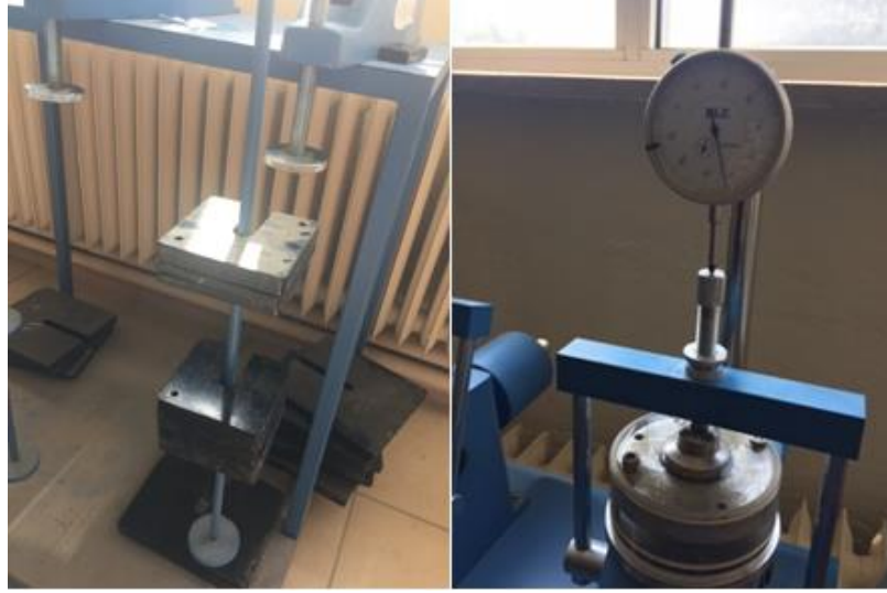
Şekil 2.3. Konsolidasyon deneyi sırasında yapılan yüklemeler ve deformasyon saati
