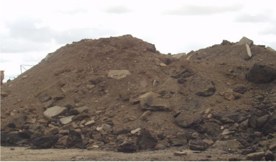
Şekil 2.7. Kazılmış RAP malzemesi
