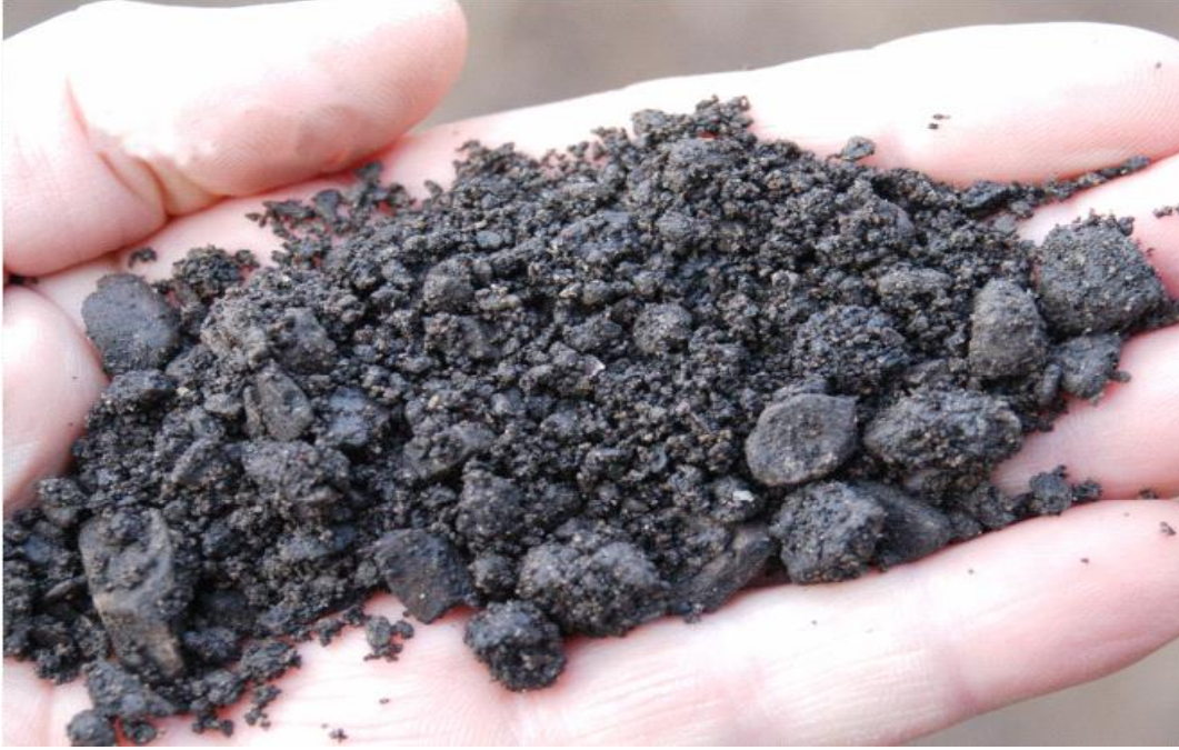
Şekil 2.10. İnce RAP malzemesi [27].
