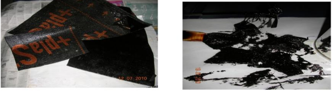
Şekil 2.16. Bitümlü membran atıkları [52].
