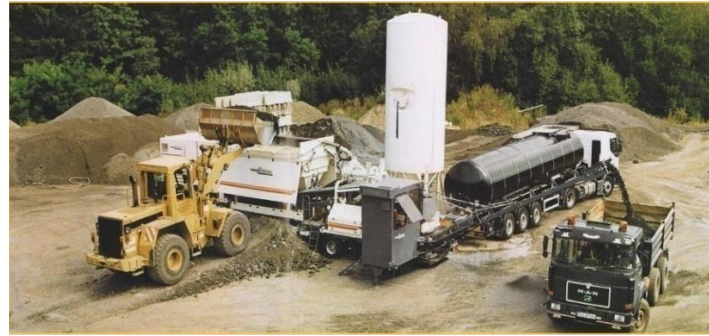
Şekil 2.23. Plentte soğuk karışım geri dönüşüm [20].
