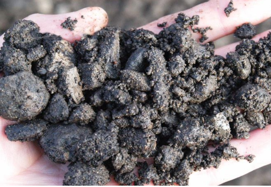
Şekil 2.11. Kaba RAP malzemesi [27].
