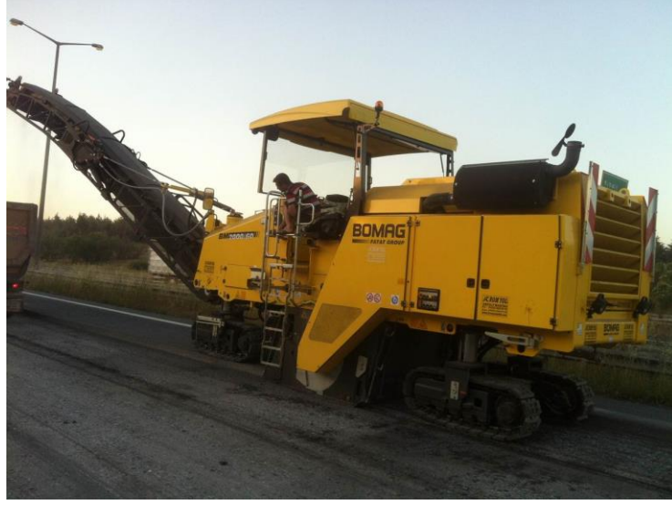
Şekil 2.25. Asfalt kazıma makinesi (Freze) [12].
