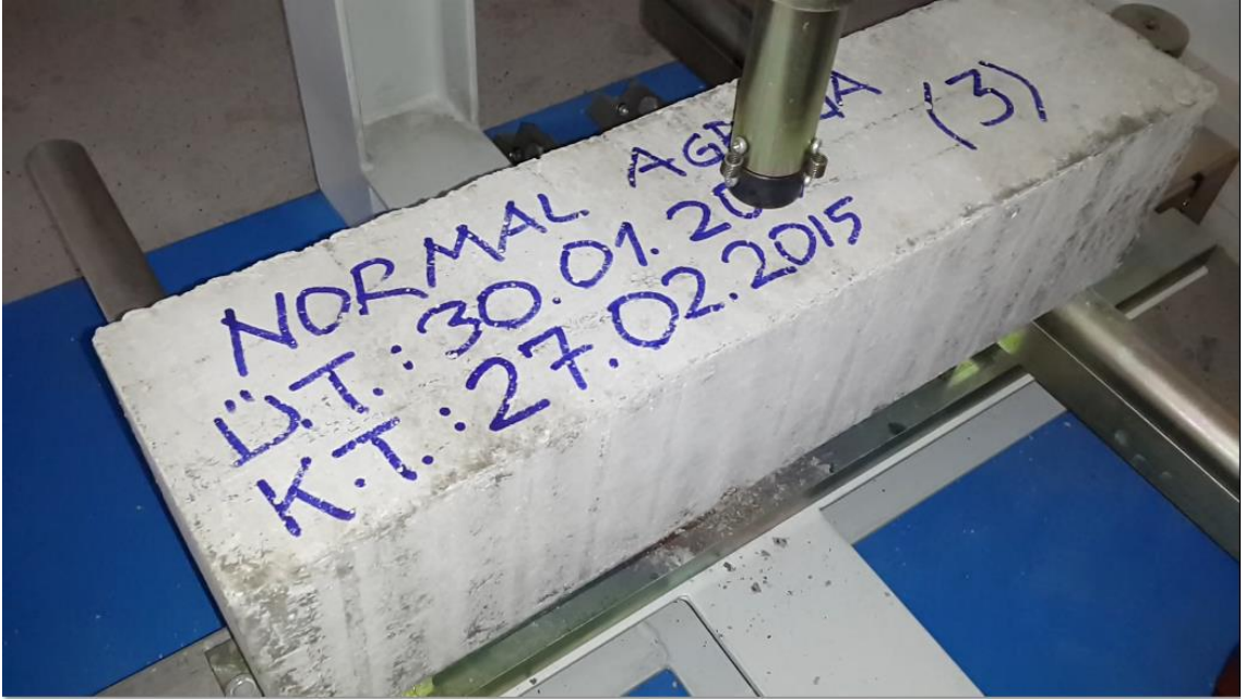
Şekil 53. NAB 3. numunenin üç nokta eğilmede çekme dayanım testi
