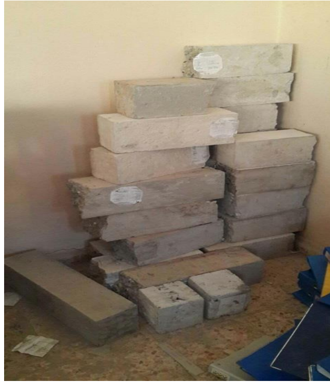
Şekil 48. Dört nokta eğilmede çekme dayanım testine tabi tutulan GDA ve NA beton karışımlarına ait numuneler
