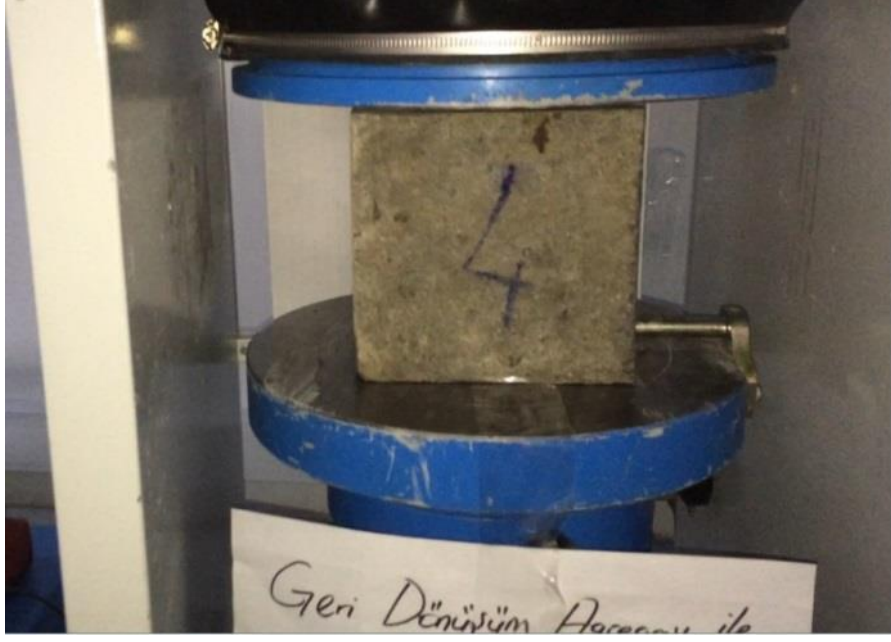
Şekil 63. TGDA B 4. kp numune basınç dayanımı testi
