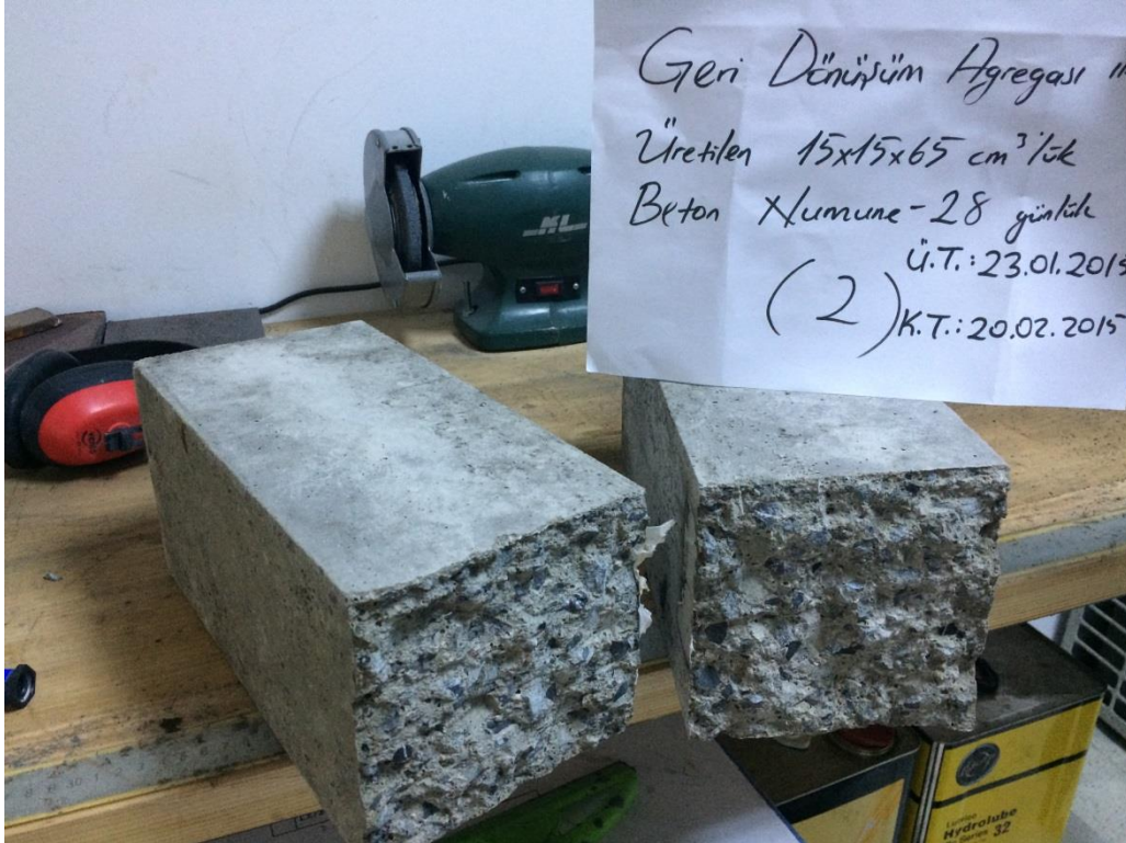
Şekil 38. TGDAB 2. numunenin kırılma şekli ve düzlemi
