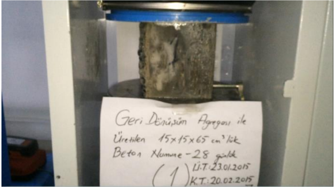
Şekil 60. TGDAB 1. küp numune basınç dayanımı testi
