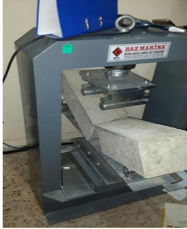
Şekil 47. %60 GDA ve %40 NA karışım oranında üretilen 3. kiriş numunenin dört nokta eğilmede çekme dayanım testi
