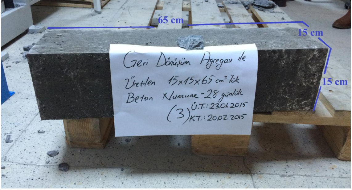
Şekil 39. Temizlenmiş geri dönüşüm agregası (TGDA) ile üretilen 3. beton kiriş numunesi
