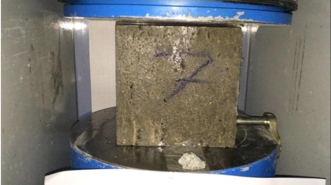
Şekil 66. TGDAB 7. küp numune basınç dayanımı testi
