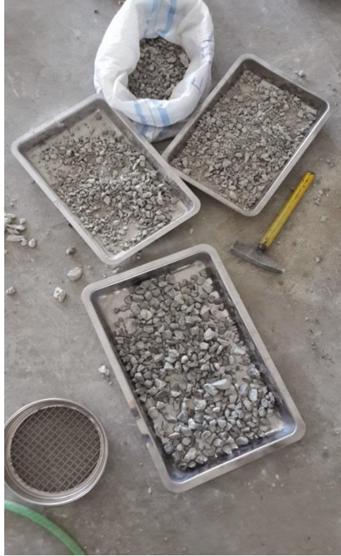
Şekil 13. Karot numunesinin çekiçle kırılarak temizlenmiş geri dönüşüm agregası (TGDA) temini
