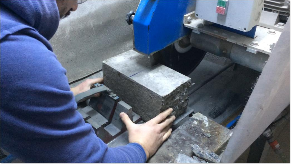
Şekil 56. Kiriş numunelerin küp numunelere dönüştürülmesi
