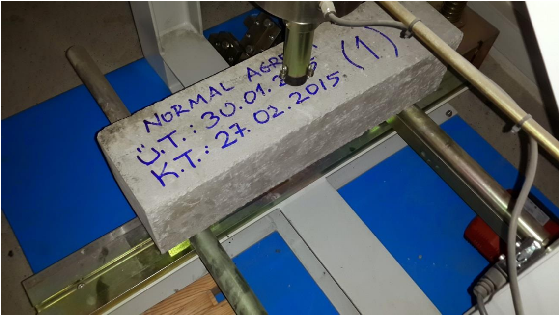
Şekil 49. NAB 1. numunenin üç nokta eğilmede çekme dayanım testi
