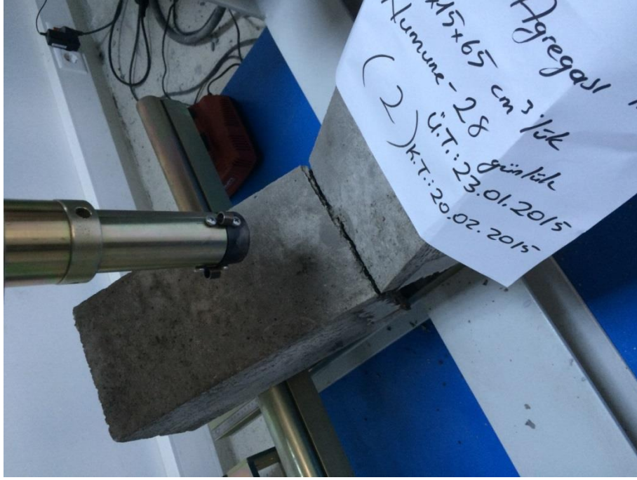
Şekil 37. TGDAB 2. numunenin kırılması
