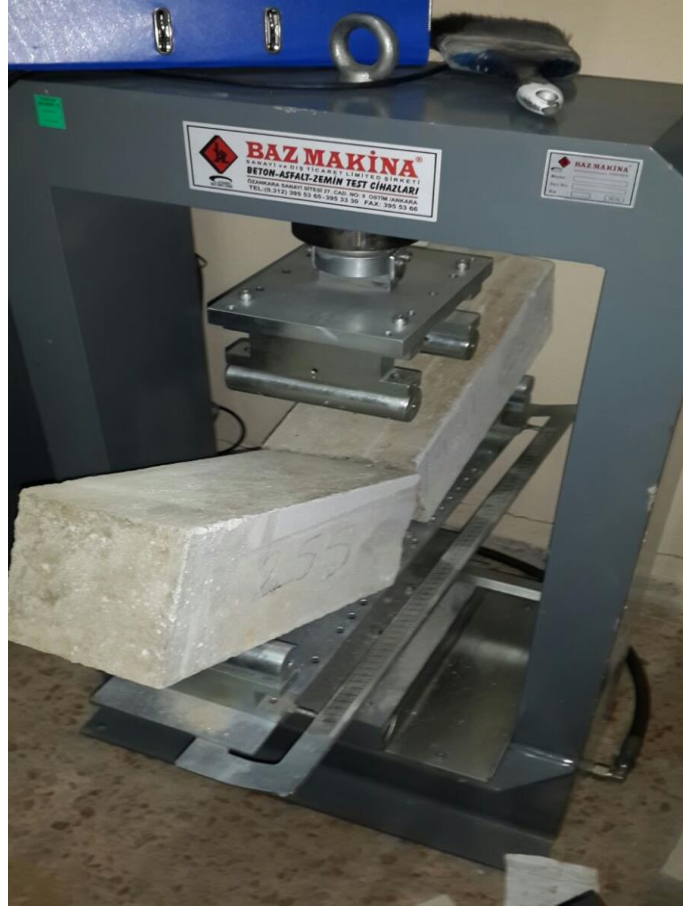
Şekil 45. %20 GDA ve %80 NA karışım oranında üretilen 2. kiriş numunenin dört nokta eğilmede çekme dayanım testi
