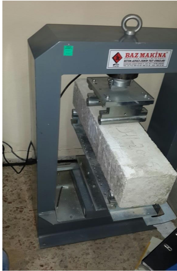
Şekil 44. %20 GDA ve %80 NA karışım oranında üretilen 1. kiriş numunenin dört nokta eğilmede çekme dayanım testi
