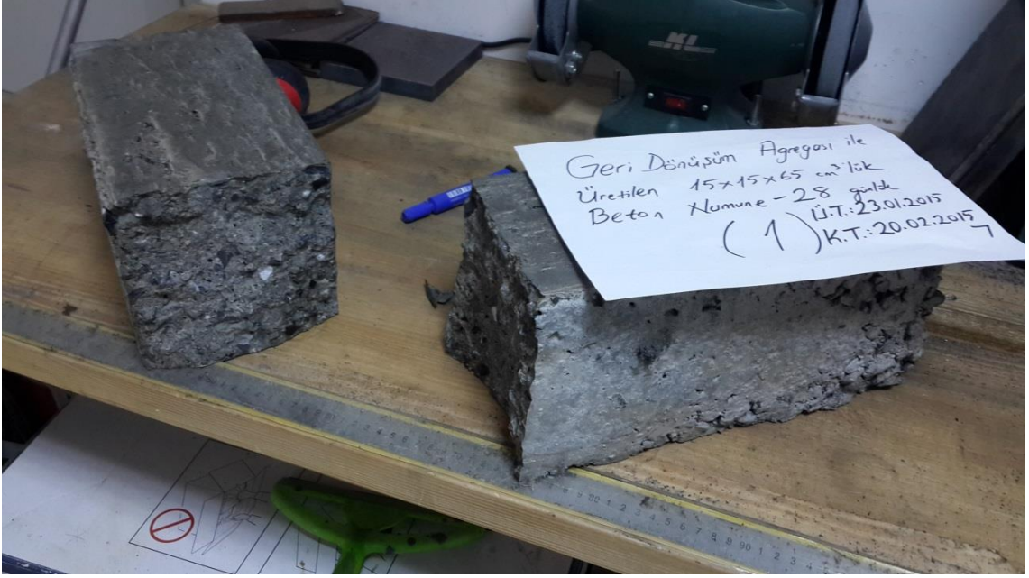
Şekil 33. TG DAB 1. numunenin kırılma şekli ve düzlemi
