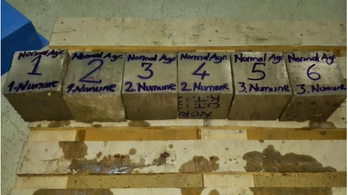
Şekil 71. NAB kiriş numunelerden 6 adet küp numune elde edilmesi
