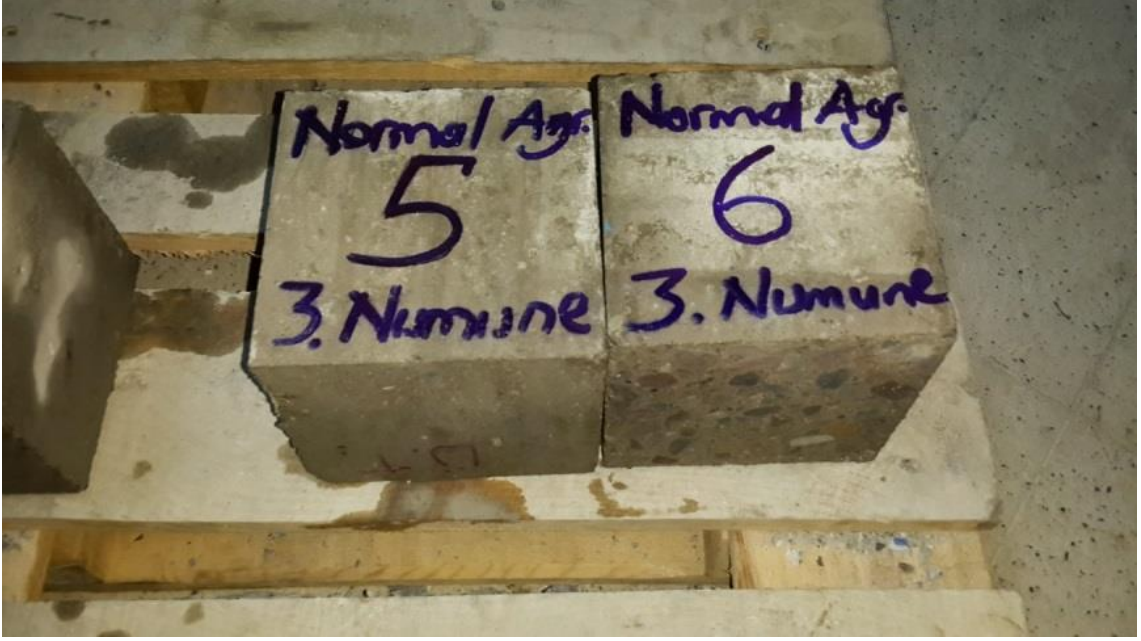
Şekil 70. NAB 3. kiriş numuneden 2 adet küp numune elde edilmesi
