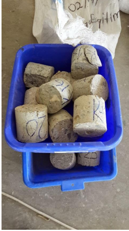
Şekil 12. Basınç dayanım testine tabi tutulan karot numuneleri
