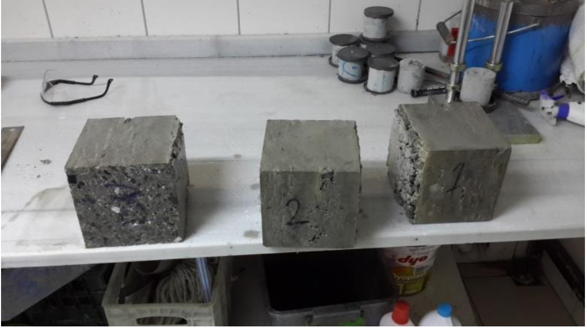
Şekil 57. TGDAB 1. kiriş numuneden 3 adet küp numune elde edilmesi
