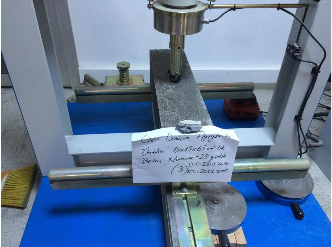
Şekil 40. TGDA B 3. numunenin üç nokta eğilmede çekme dayanım testi
