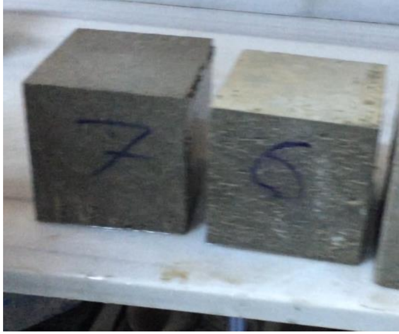
Şekil 59. TGDAB 3. kiriş numuneden 2 adet küp numune elde edilmesi
