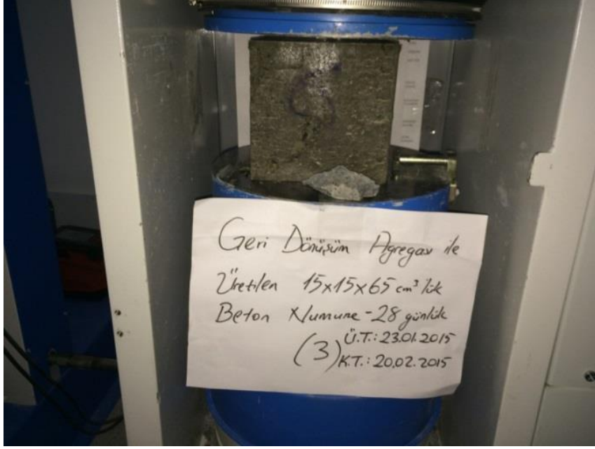
Şekil 65. TGDAB 6. küp numune basınç dayanımı testi
