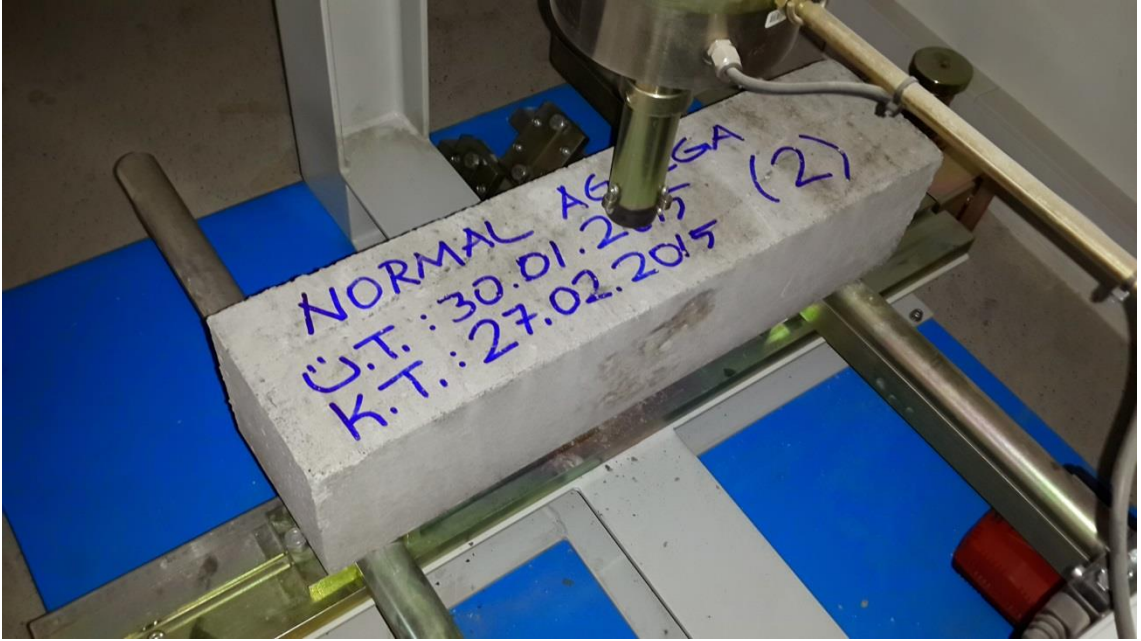
Şekil 51. NAB 2. numunenin üç nokta eğilmede çekme dayanım testi
