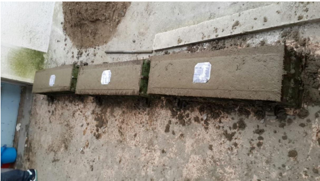
Şekil 23. Kiriş kalıplara %20 GDA ve %80 NA karışım betonunun yerleştirilmesi
