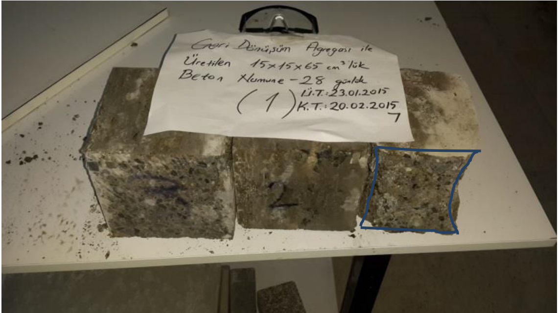
Şekil 79. TGDAB 1. numunenin basınç dayanımı testi sonrası kırılma yüzeyleri
