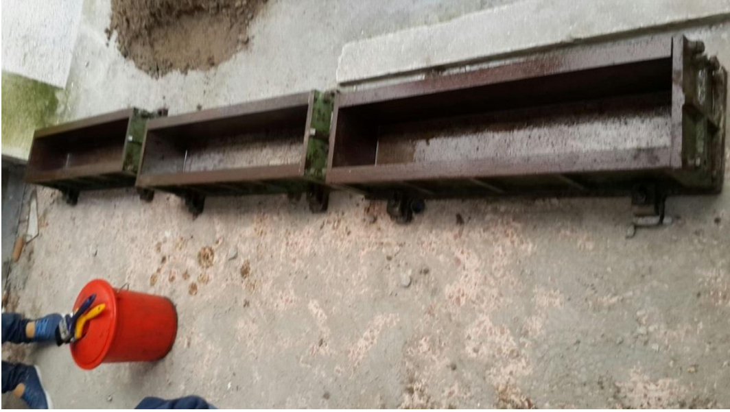
Şekil 22. Kiriş numune kalıplarının temizlenmesi ve yağlanması
