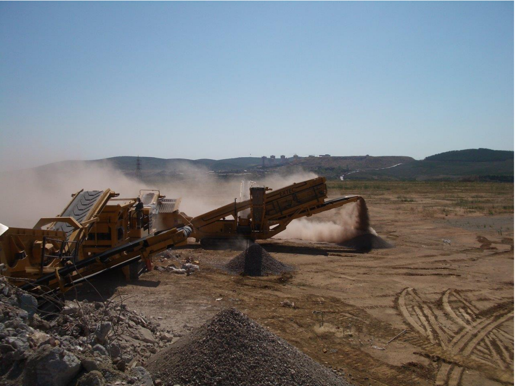
Şekil 6. İnşaat yıkıntı atıklarının geri kazanım tesisinde ayrıştırılması [47].
