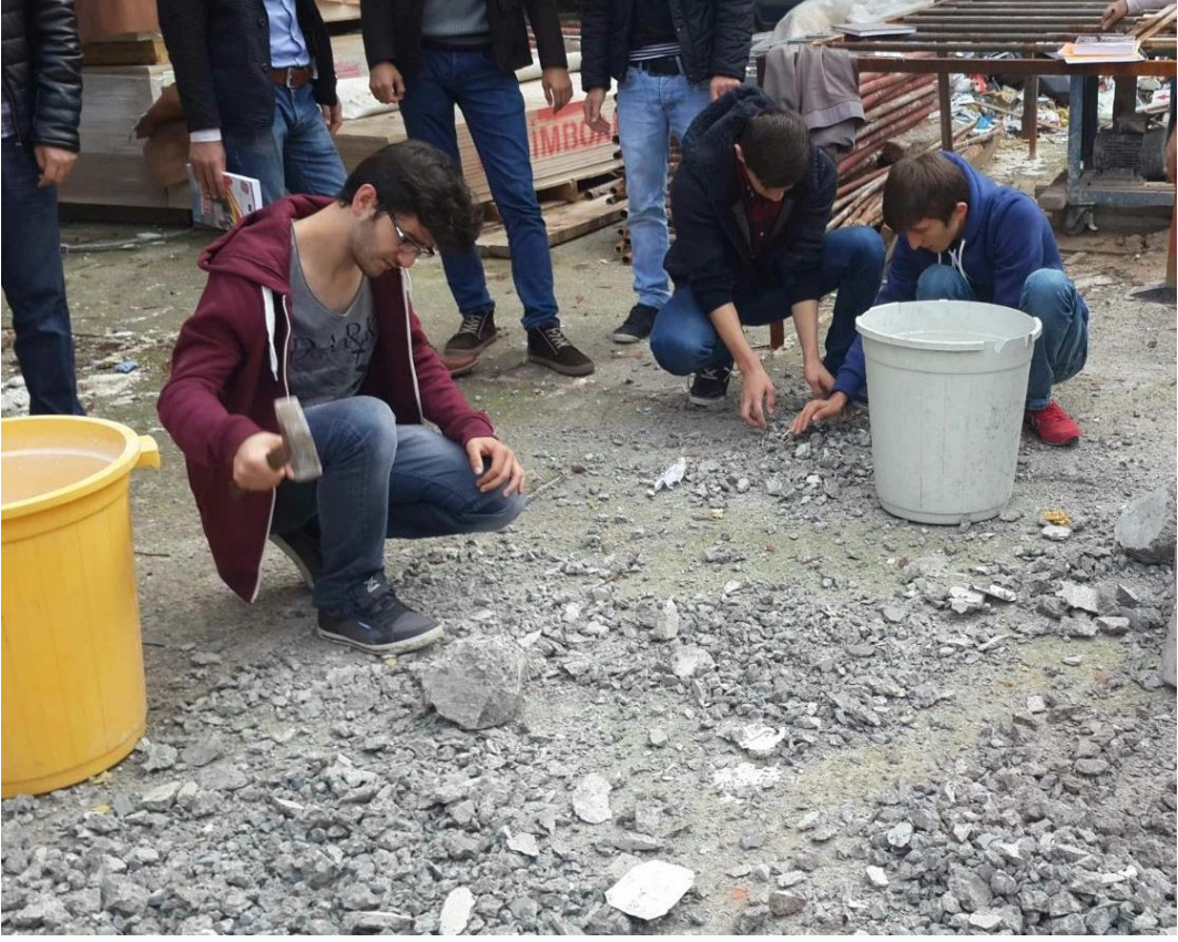
Şekil 16. Beton inşaat yıkıntı atığının (İYA) çekiçle kırılarak geri dönüşüm agregası (GDA) temini
