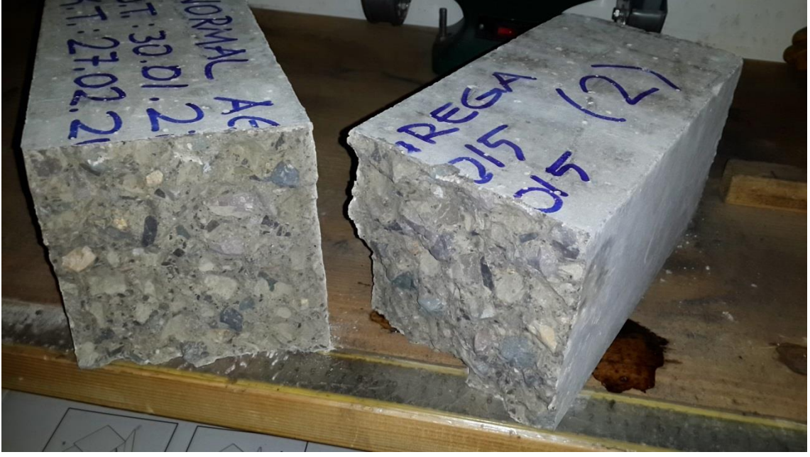
Şekil 52. NAB 2. numunenin kırılma şekli ve düzlemi
