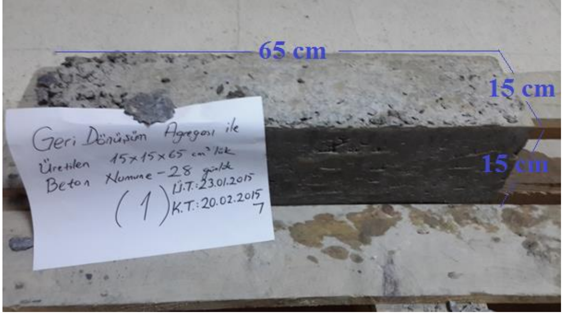
Şekil 31. Temizlenmiş geri dönüşüm agregası (TGDA) ile üretilen 1. beton kiriş numunesi
