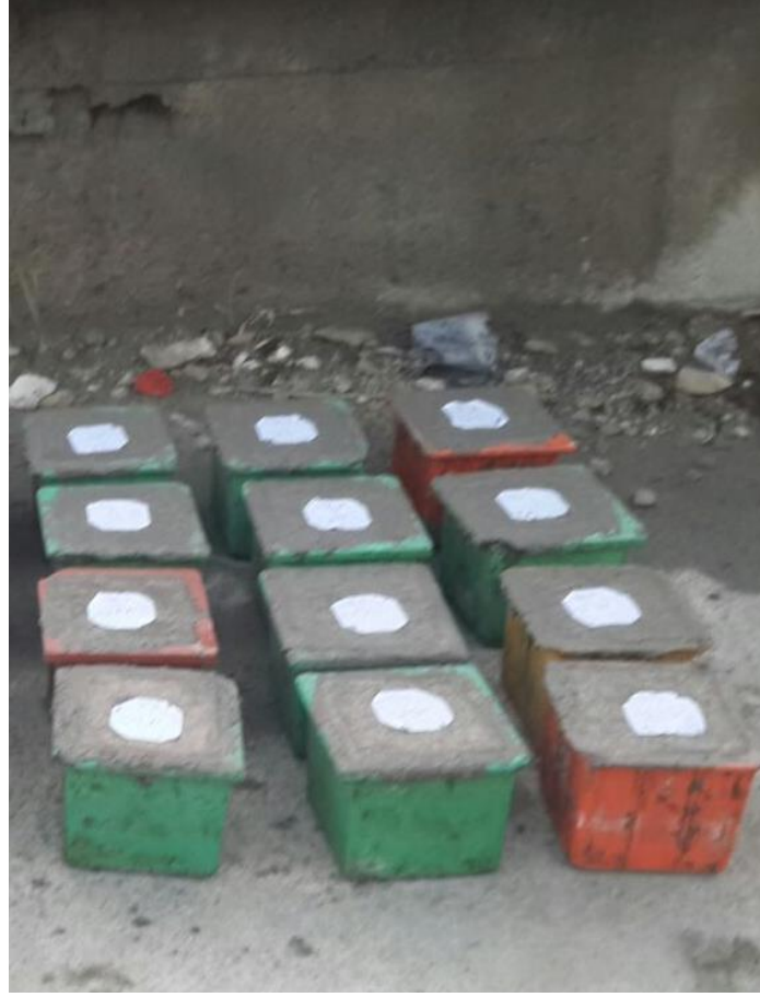
Şekil 67. Farklı karışım oranlarında GDA ve NA ile üretilen 12 adet küp numune
