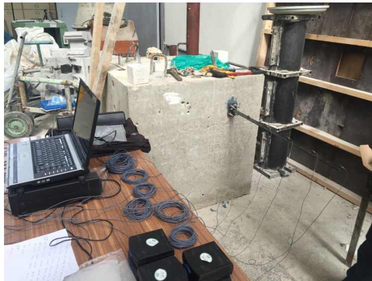
Şekil 22. Konsol kiriş için oluşturulan ölçüm düzeneği ve ivmeölçer yerleşimi
