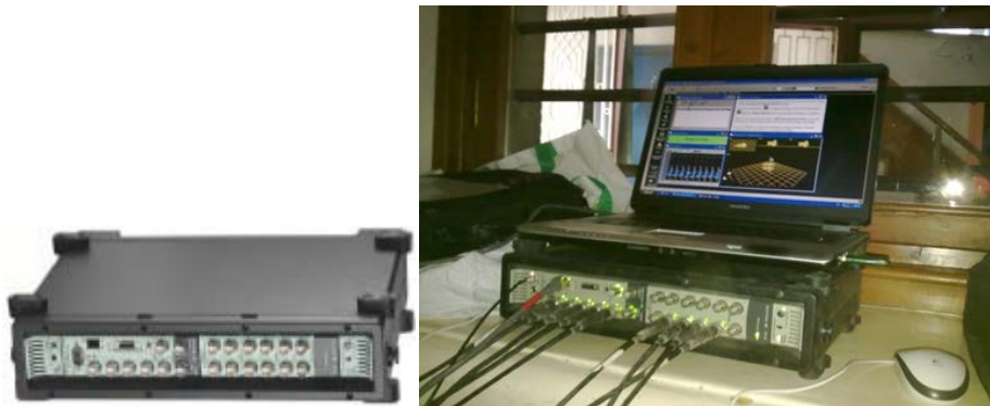
Şekil 10. B&K3560-C tipi on yedi kanallı veri toplama ünitesi
