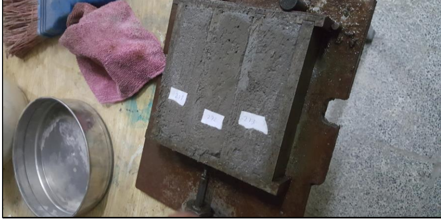
Şekil 2.22. Puzolanik aktivite ölçmek için kullanılan numune kalıpları
