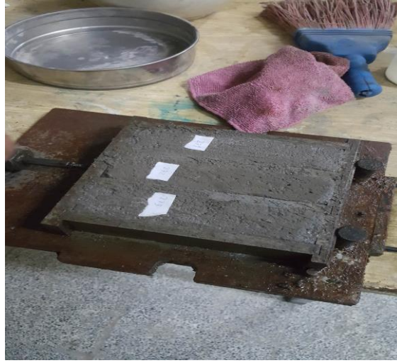
Şekil 2.46. 40×40×160 mm üçlü numune kalıbı
