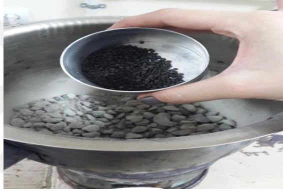
Şekil 66. Agregalara ve elyaf karışımına Pr Plast S eklenmesi
