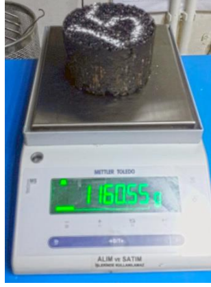
Şekil 57. Marshall briketlerinin havada ağırlıklarının ölçülmesi
