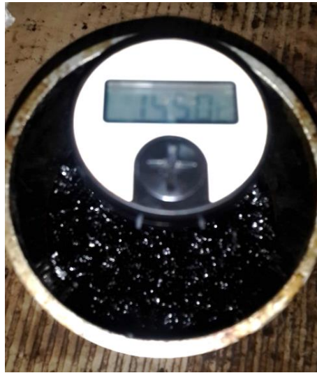
Şekil 70. Karışımın sıkıştırılmadan önce uygun sıcaklığa gelmesi için kontrol edilmesi
