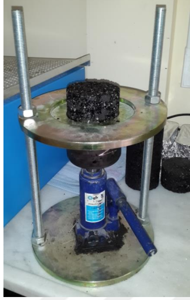
Şekil 74. Karışımın kalıptan çıkarılması
