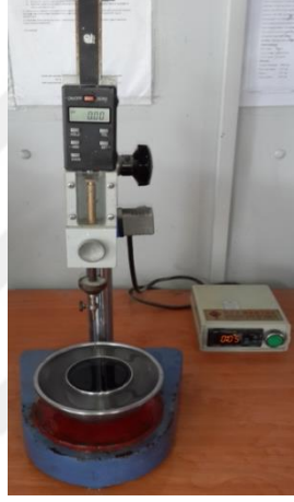
Şekil 42. Penetrasyon deneyi yapılışı
