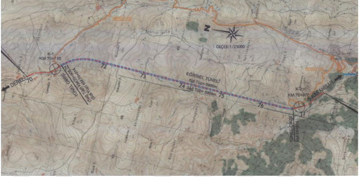
Şekil 40.Eğribel tüneli güzergahı
