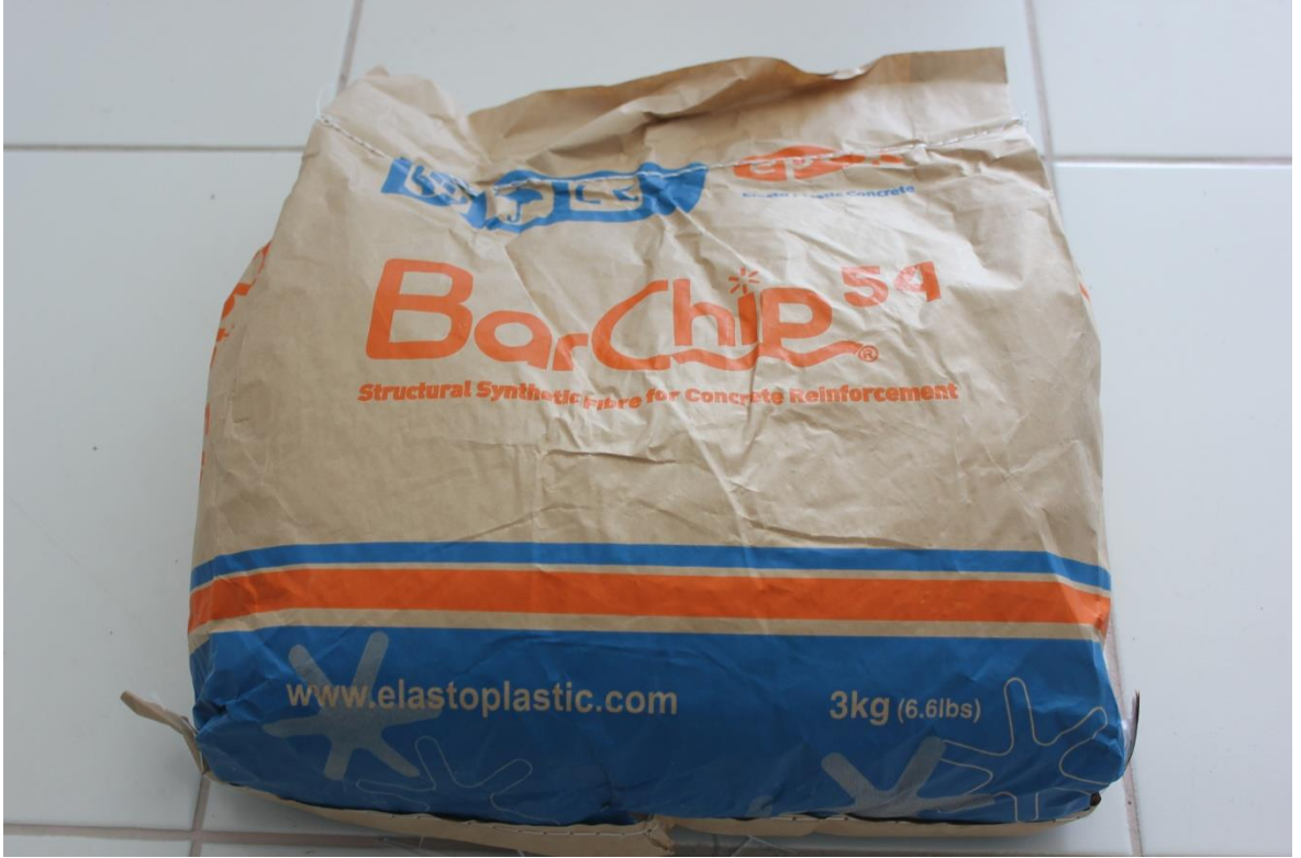
Şekil 72. 3 kilogramlık paketlenmiş sentetik fiber donatı
