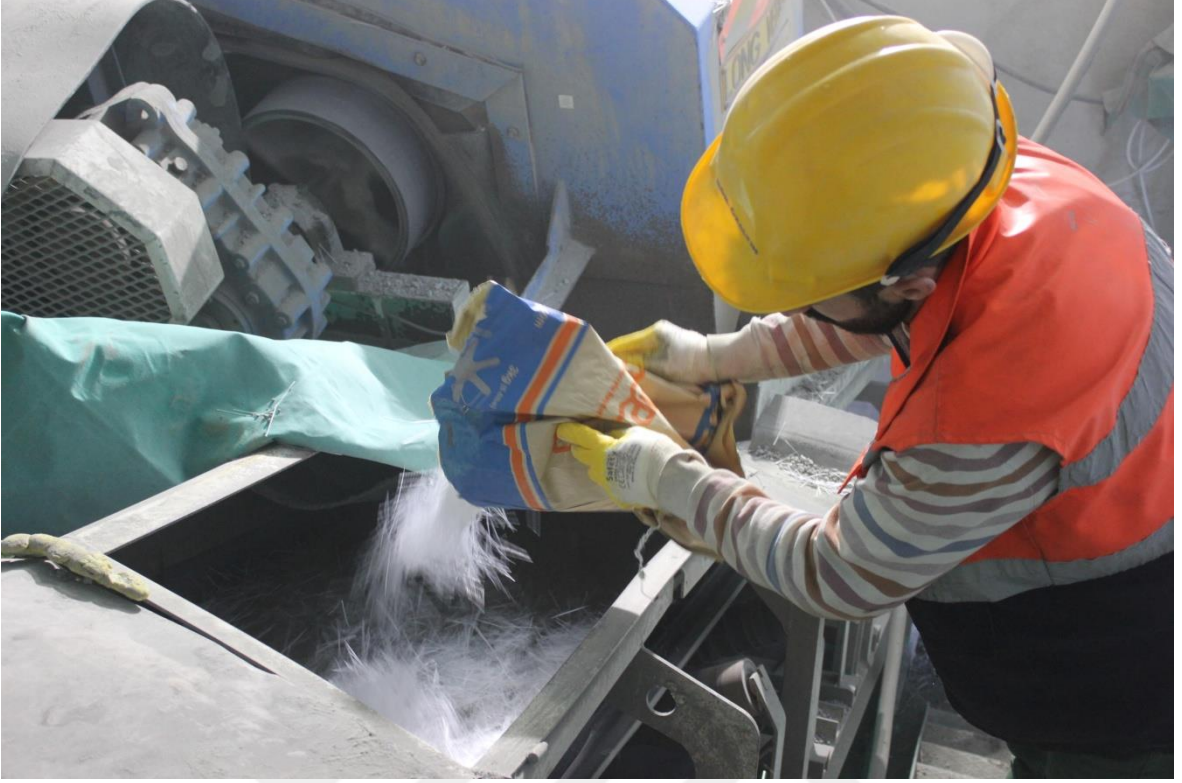
Şekil 75. Sentetik fiber donatı malzemesinin beton üretimine karışımı
