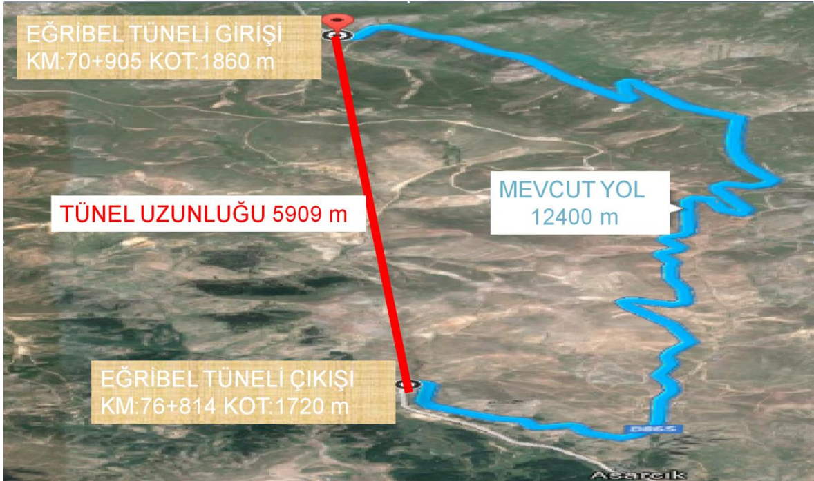
Şekil 41. Eğribel tünelinin yolu ne kadar kısalttığının gösterimi
