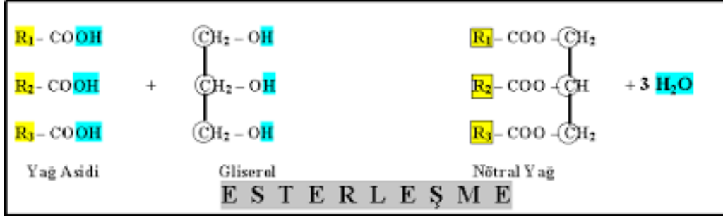
Şekil 6. Yağ asitlerinin gliserinle esterleşmesi
