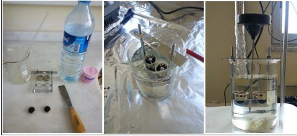
Şekil 15. Yumuşama noktası deney adımları
