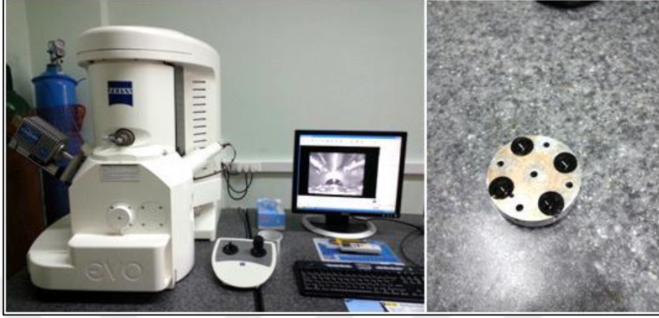
Şekil 14. SEM cihazı (1) ve karbon bant üzerindeki bitüm numuneleri (2)
