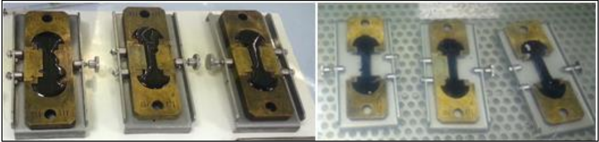
Şekil 18. Force düktilite deneyi numuneleri ((a)oda sıcaklığında, (b)su banyosunda)
