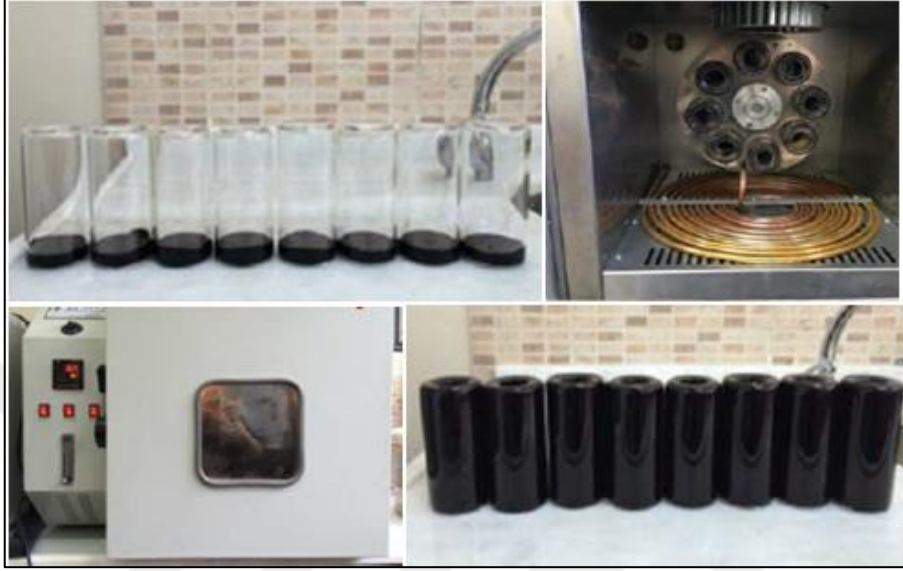
Şekil 22. RTFOT deney numuneleri ve deney yapılış adımları
