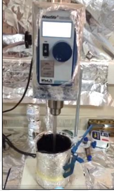
Şekil 24. Modifiye bitüm numunelerinin elde edilmesi
