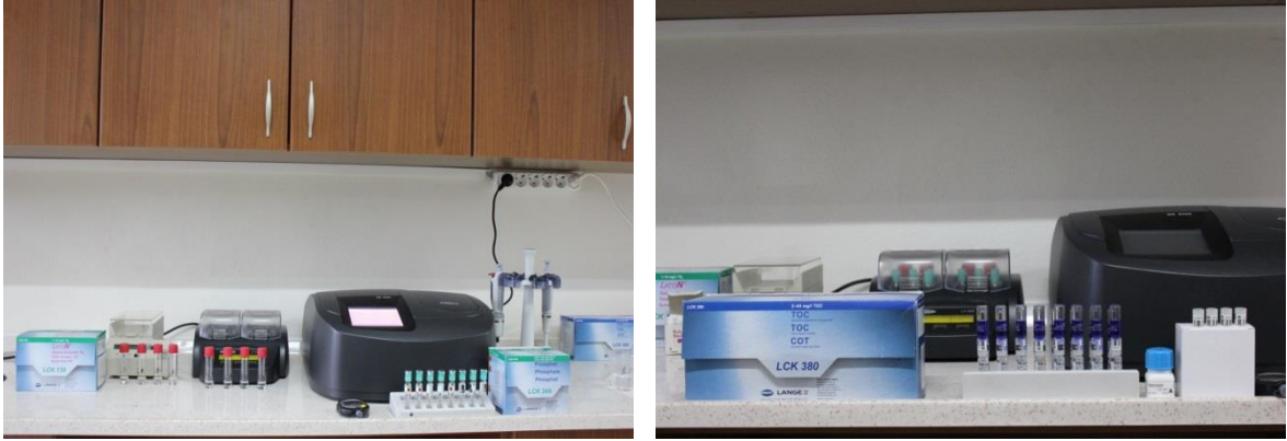
Şekil 29. Termoreaktörler, spektrofotometre ve kullanılan küvet testler
