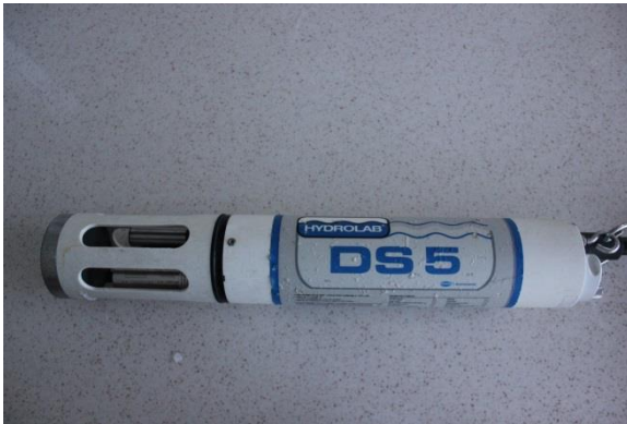
Şekil 26. Yerinde ölçüm alınan DS5 cihazı
