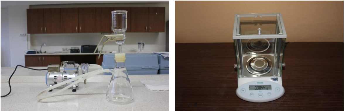
Şekil 28. Vakumlu filtrasyon seti, vakum pompası ve hassas terazi
