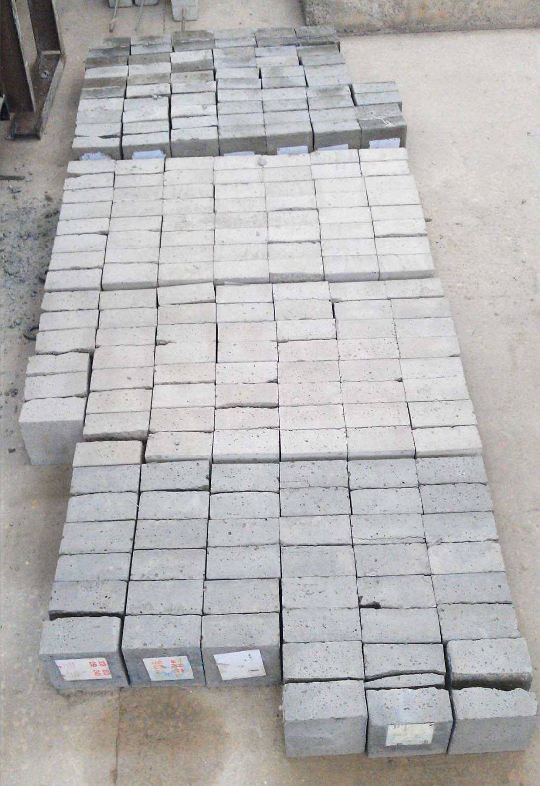
Şekil 2.18. Çalışmada gerçekleştirilen yarma deneyleri sonunda numunelerden bir görünüm
