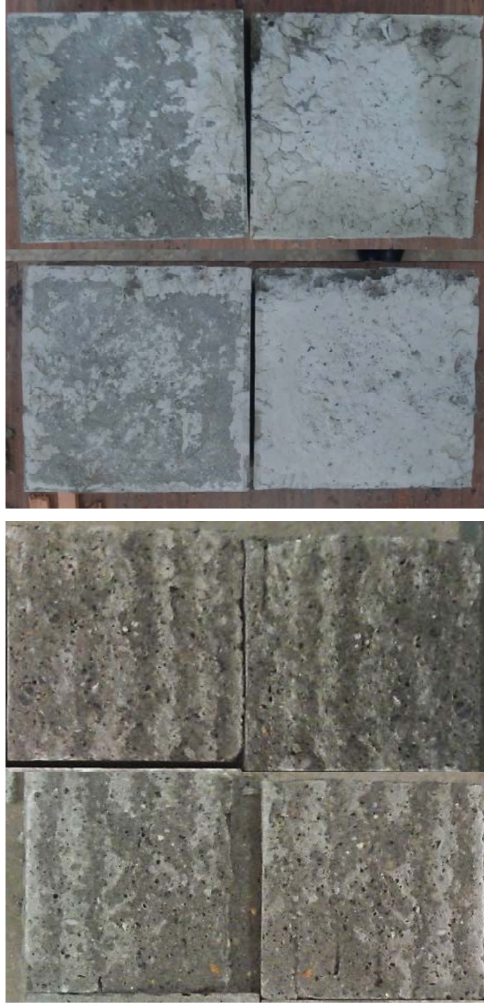
Şekil 2.17. Eski beton yüzeyine çimento şerbeti ve pürüzlendirme uygulamaları yapılmış numunelerin deney sonrası görünümleri
