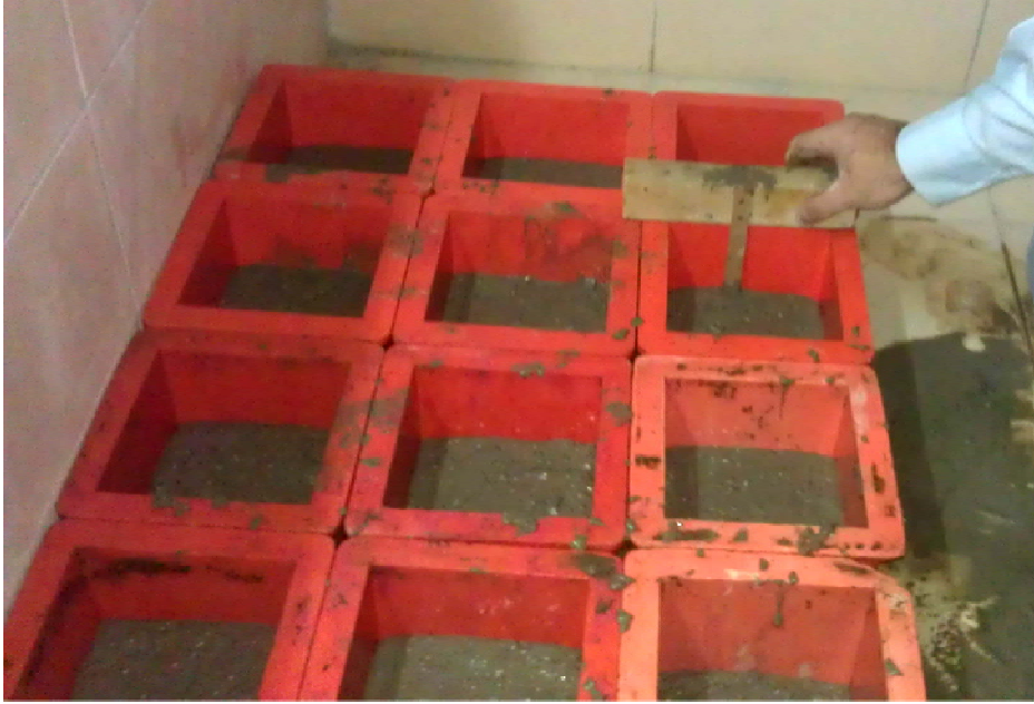
Şekil 2.3. Üretilen betonun küp numunelere yarı yükseklikte yerleştirilmesi
