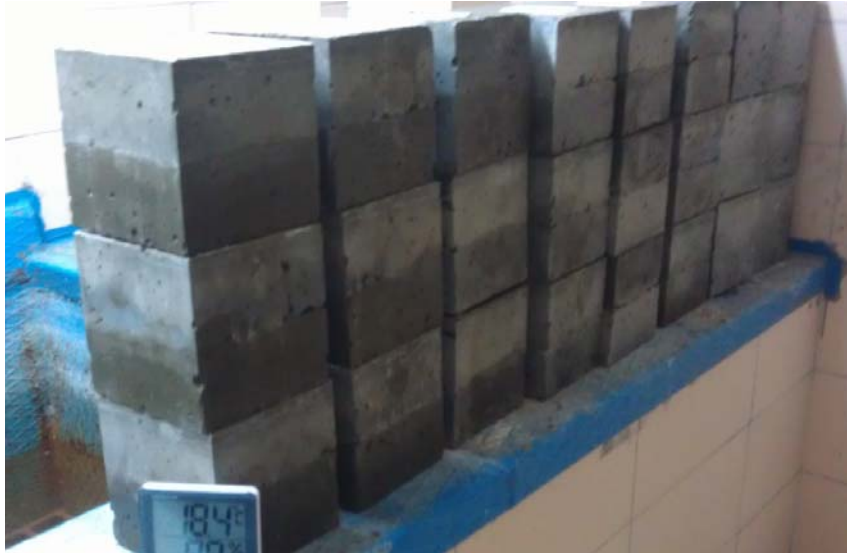
Şekil 2.7. Kür odasında deney gününü bekleyen numunelerden bir görünüm
