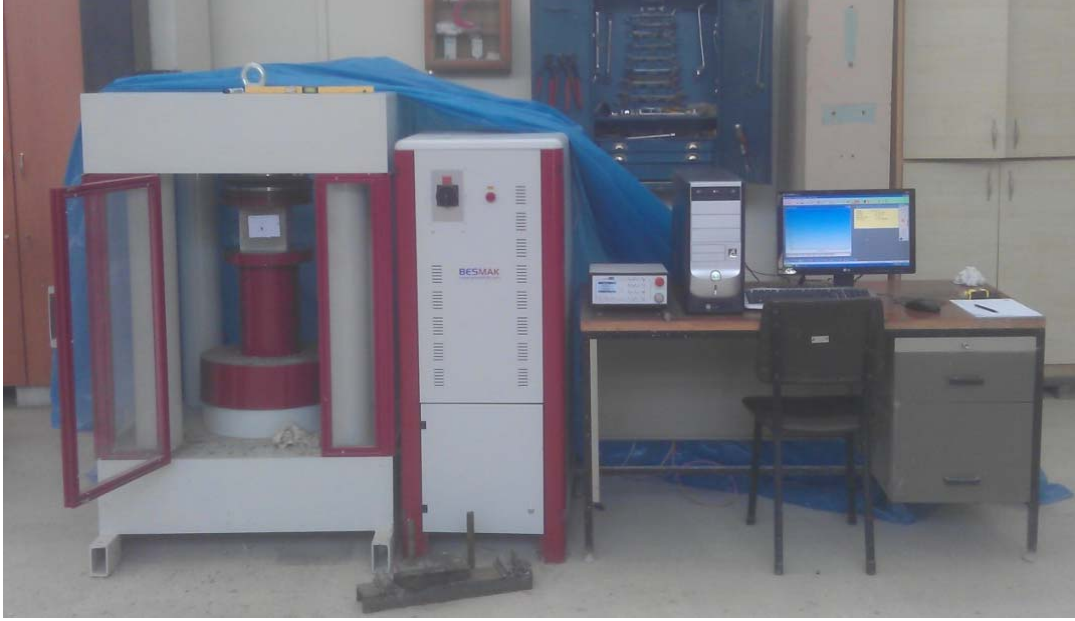
Şekil 2.8. Merkezi basınç deney anından bir görünüm
