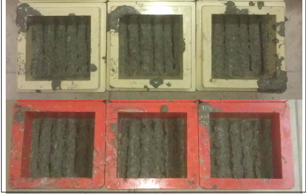
Şekil 2.5. Yüzey pürüzlendirme uygulanmış numunelerden bir görünüm
