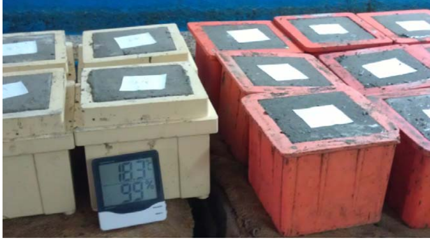
Şekil 2.6. Kür odasında kalıplarında bekleyen numunelerden bir görünüm
