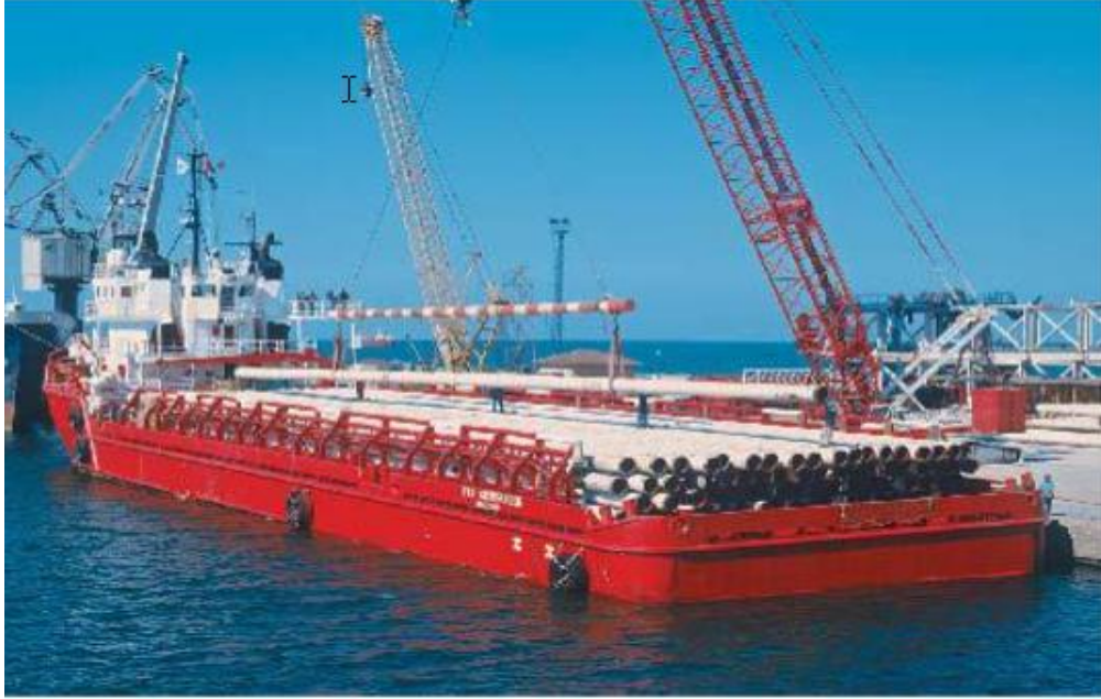
Şekil 3.23. Boru döşeme operasyonunda döşeme gemisine boru taşıyan yardımcı gemi
