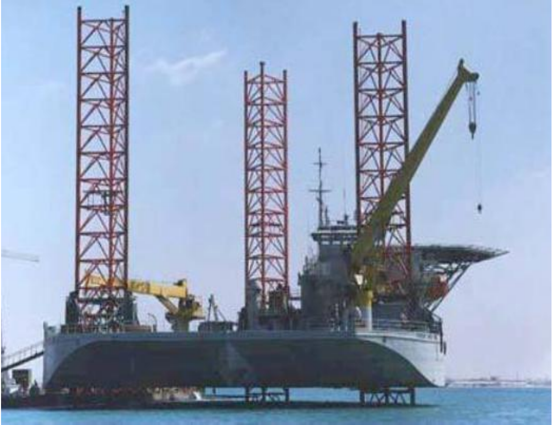
Şekil 3.19. Deniz altında boru hattı döşenmesinde kullanılan bir mobil krikolar platformu
