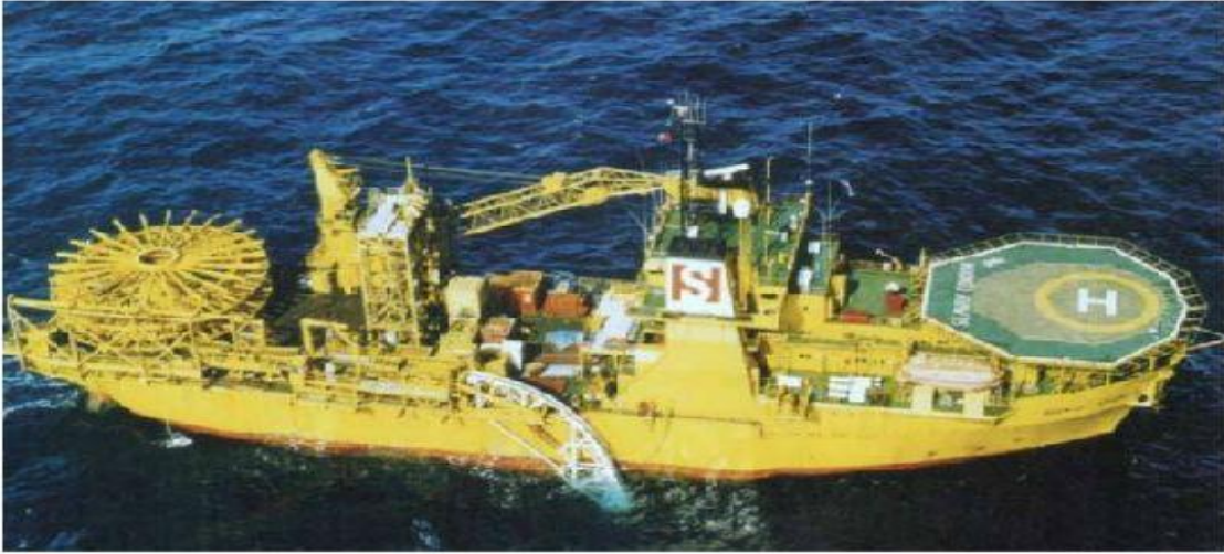
Şekil 3.24. Makaralı bir düzeneğe sahip olan döşeme gemisi
