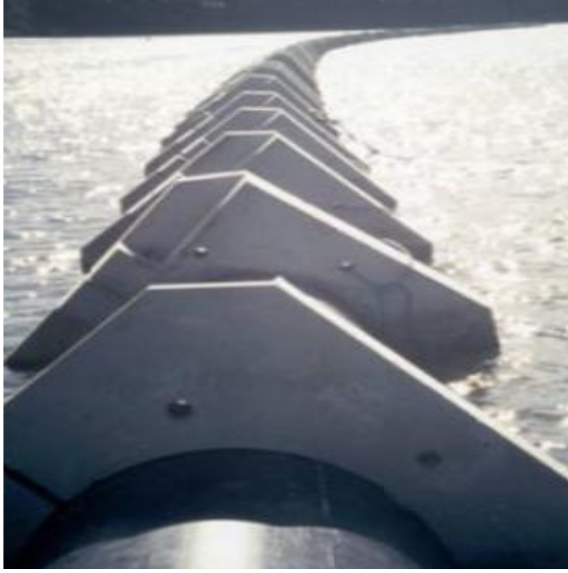
Şekil 3.7. YYPE borular için batırma blokları
