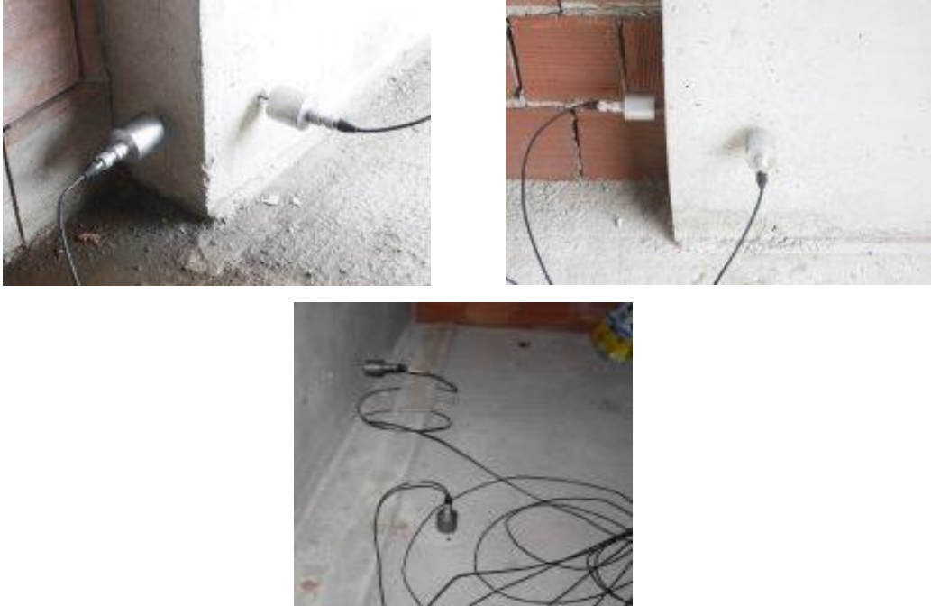
a. Yatay ve düşey ivmeölçerlerin montajı
