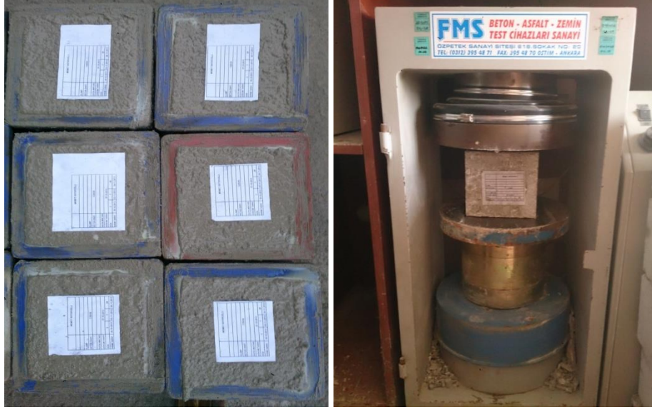
Şekil 13. Küp numunelerin basınç dayanımlarının belirlenmesi
