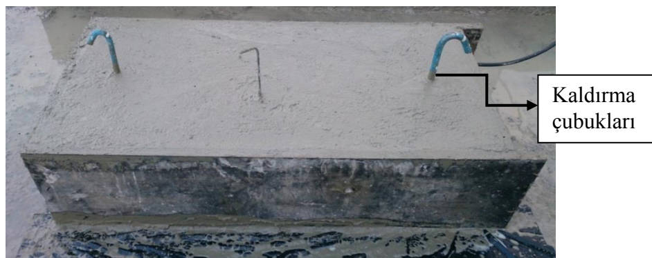
Şekil 15. 20 cm beton döküldükten sonra numunenin durumu
