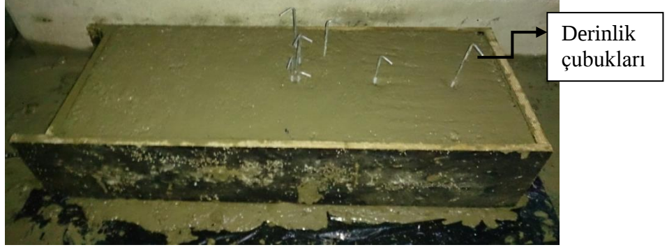
Şekil 16. Numuneye demir çubukların yerleştirilmesi
