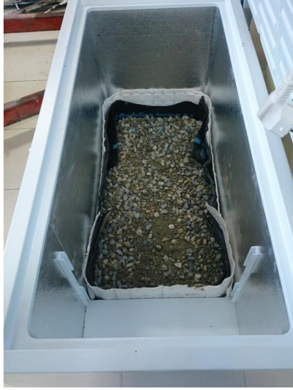
Şekil 17. Derin dondurucu ve beton kaplama altına konulan zemin
