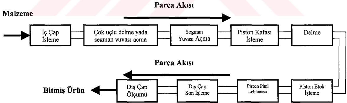
Şekil 6 : Tek Parça Akış Hattı Örneği (Süreç Bazlı Piston Üretim Hattı)
