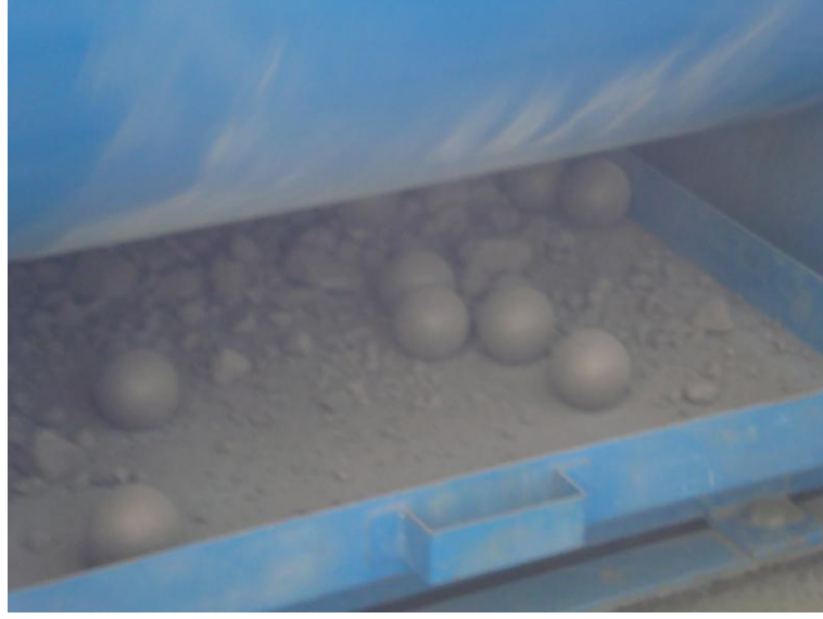
Şekil 4. Los Angeles aşınma kaybı deneyinin yapılması
