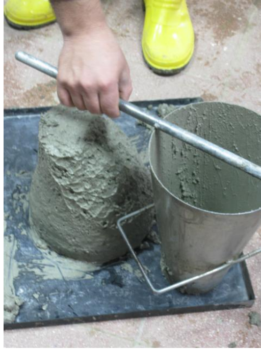
Şekil 14. Taze betonda çökme deneyi
