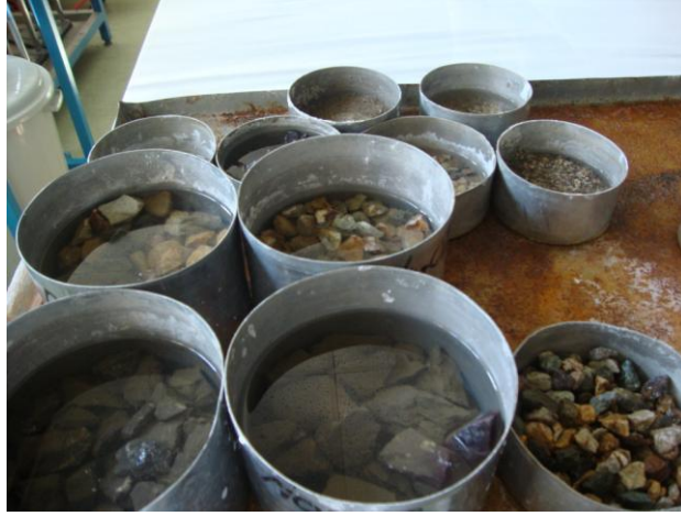
Şekil 8. Sodyum sülfat don kaybı deneyinin yapılması
