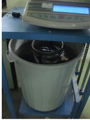
Şekil 5.Yoğunluk, bağıl yoğunluk ve su emme deneyi seti ( İri agregada )
