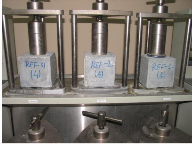
Şekil 16. Basınçlı geçirgenlik deneyi düzeneği
