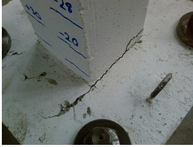
Şekil 3.14 PC-4 numunesinde kırılma
