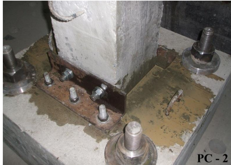
řekil 2.13. PC-2 nolu deney numunesinin temel birleřimi
