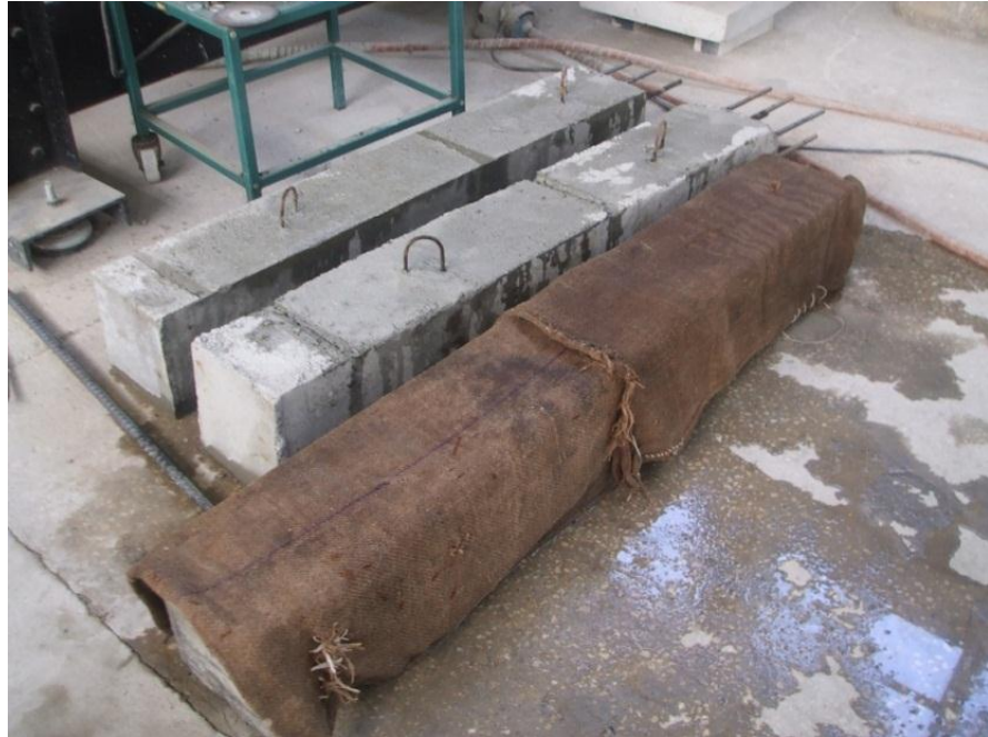
Şekil 2.11. Kolonların ıslak çuvallarla kürü
