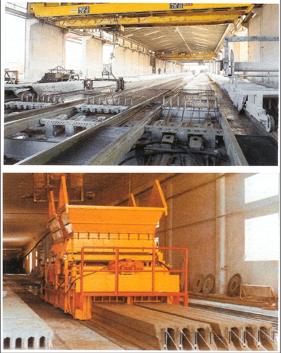
Şekil 1.17 Prefabrike döşeme üretim hattı ve makinesi (Uçar, Barka, 2011)
