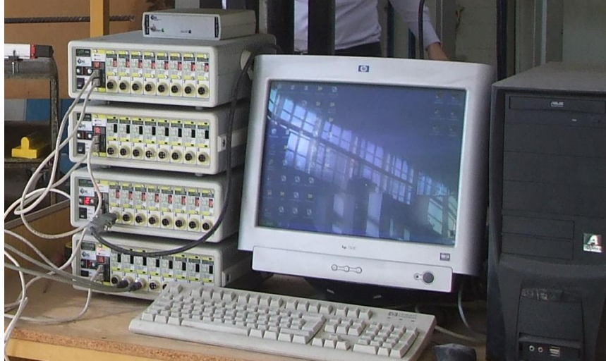
Şekil 2.22. TDG marka 32 kanallı veri kayıt sistemi (Data-logger)
