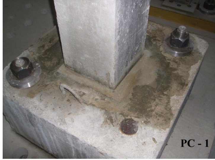
řekil 2.12. PC-1 nolu deney numunesinin temel birleřimi
