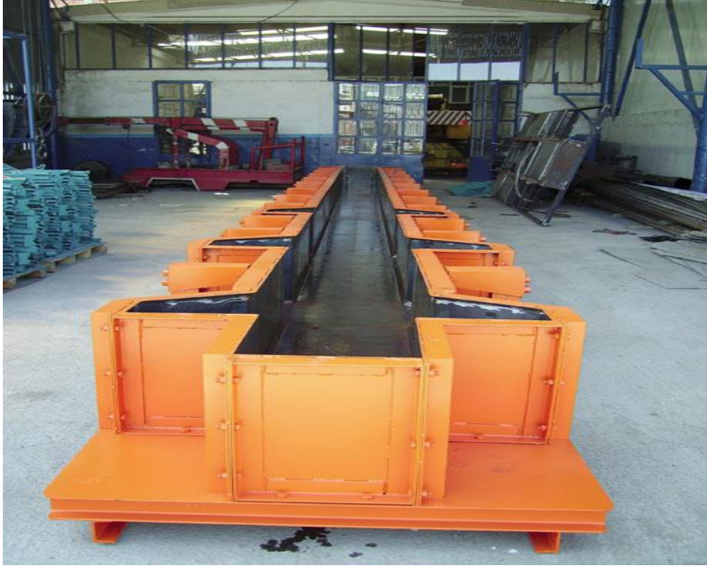
Şekil 1.11 Prefabriğe kolon yapımında kullanılan bir kalıp
