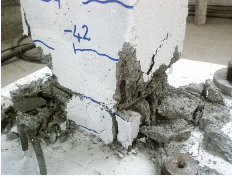
Şekil 3.20. RC kolonunda oluşan kırılma ve donatı burkulması
