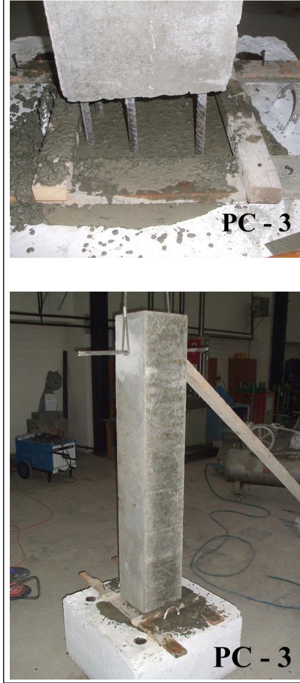
Şekil 2.14. PC-3 nolu deney numunesinin temele yerleştirilmesi
