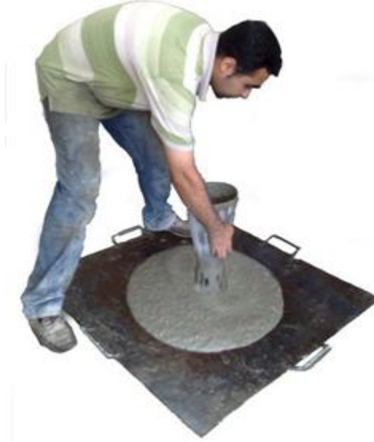
Şekil 1.1. KYB nin taze haldeyken akışkanlığının görüntüsü
