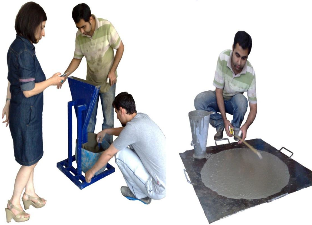
Şekil 8.11. Üretilen KYB lerin taze hal deneyleri
