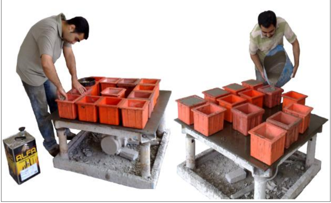
Şekil 8.12. Hazırlanan KYB lerin kalıplara yerleştirilmesi
