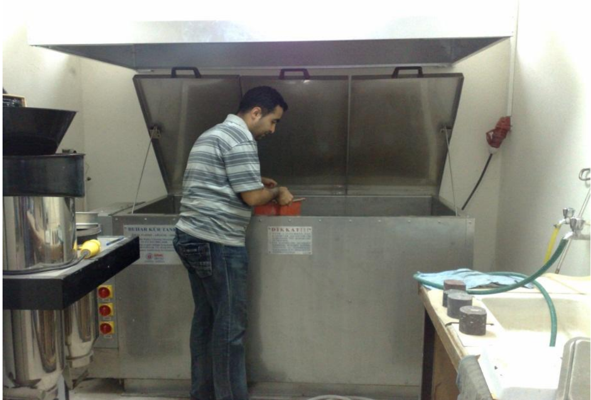
Şekil 8.14. Buhar kürü tankına numune yerleştirme
