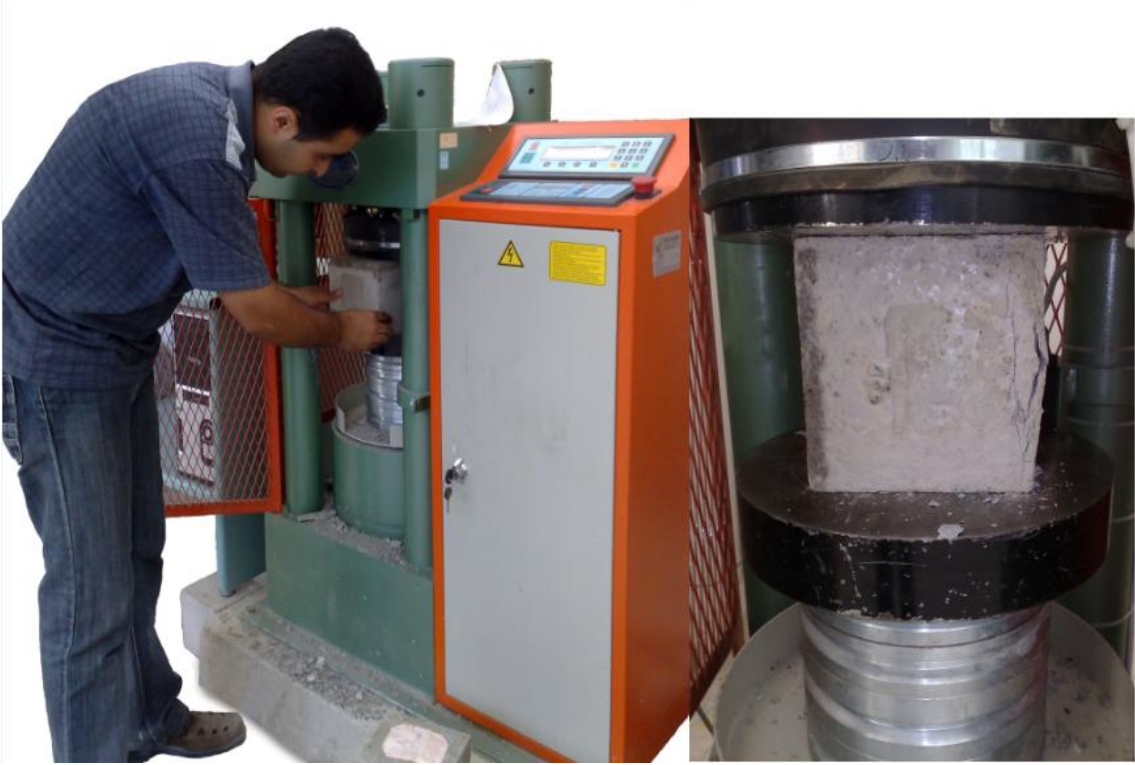
Şekil 8.17. Basınç dayanımının uygulamasının belirlenmesi
