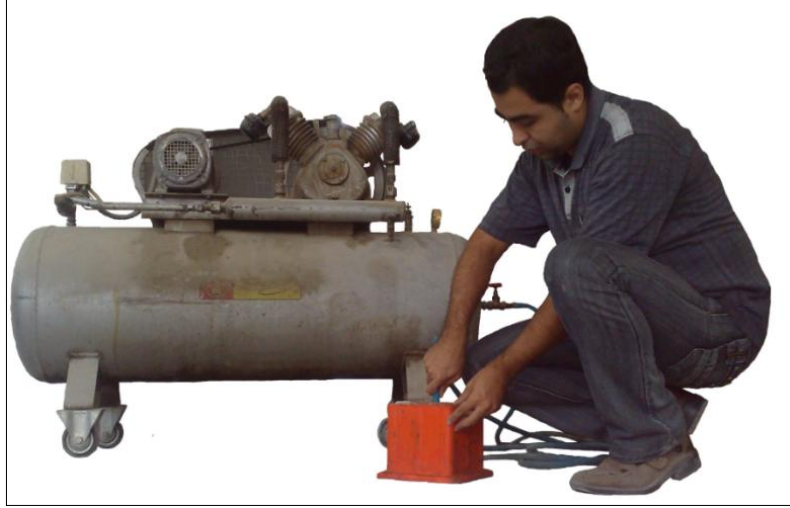
Şekil 8.15. Numunelerin hava püskürterek kalıptan çıkarması
