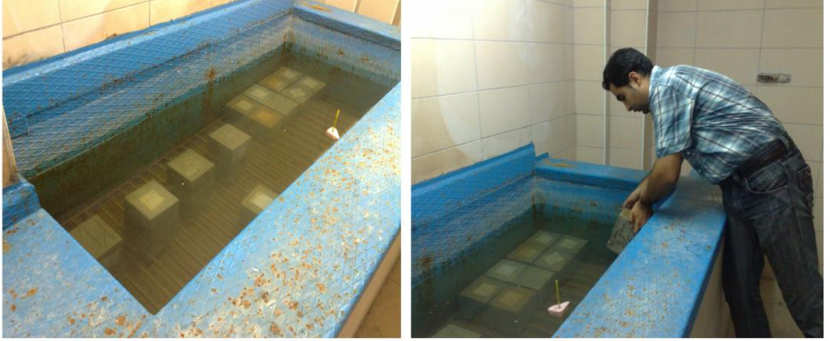
Şekil 8.18. KTÜ, Yapı ve Yapı malzemesi laboratuvarının k r havuzuna, deneyler i in hazırlanan KYB lerin yerleřtirilmesi
