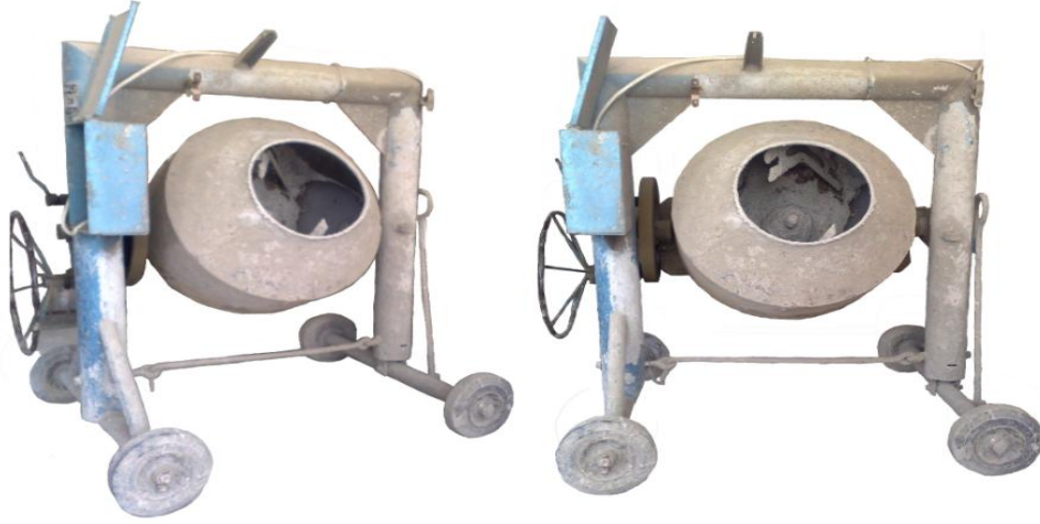
Şekil 8.6. KTÜ Yapı ve Yapı malzemesi laboratuvarında var olan NACE markalı eğik eksenli betoniyer
