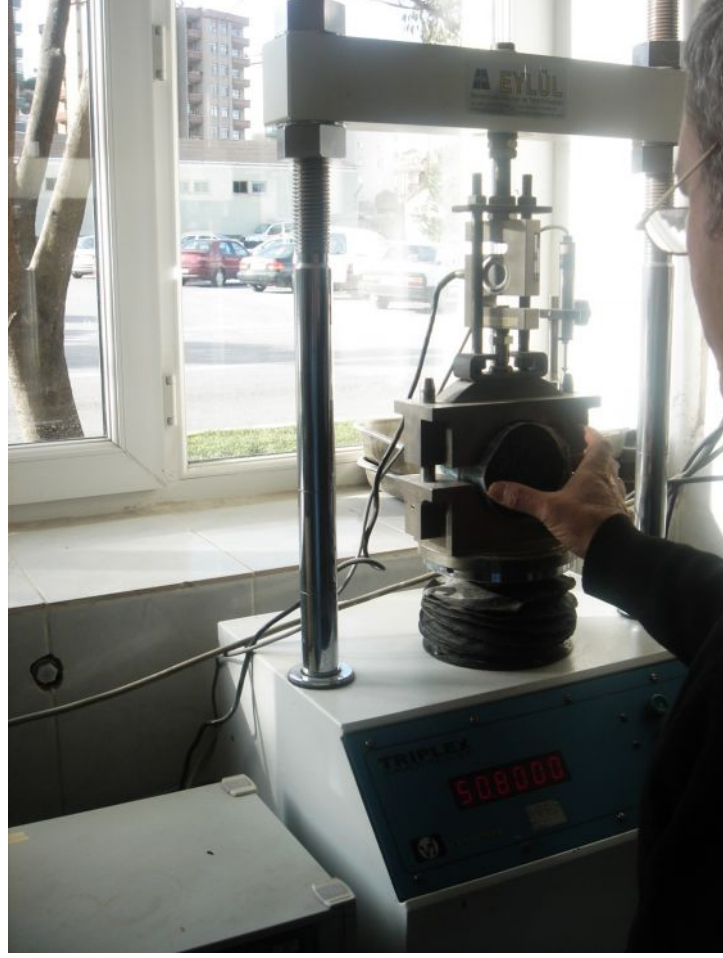
Şekil 5. Stabilite ve akma değerlerini ölçen alet
