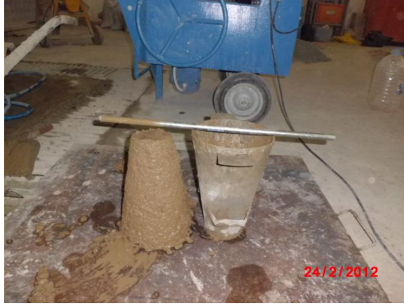
Şekil 4.10. Çökme (Abrams hunisi) deneyi
