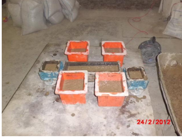
Şekil 4.8.Hazırlanan karışımların kalıplara yerleştirilmesi
