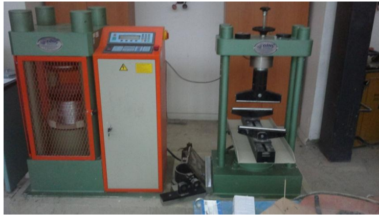
Şekil.4.6. Eğilme ve basınç test presi
