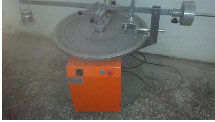
Şekil 4.7. Böhme yüzey aşındırıcı test cihazı
