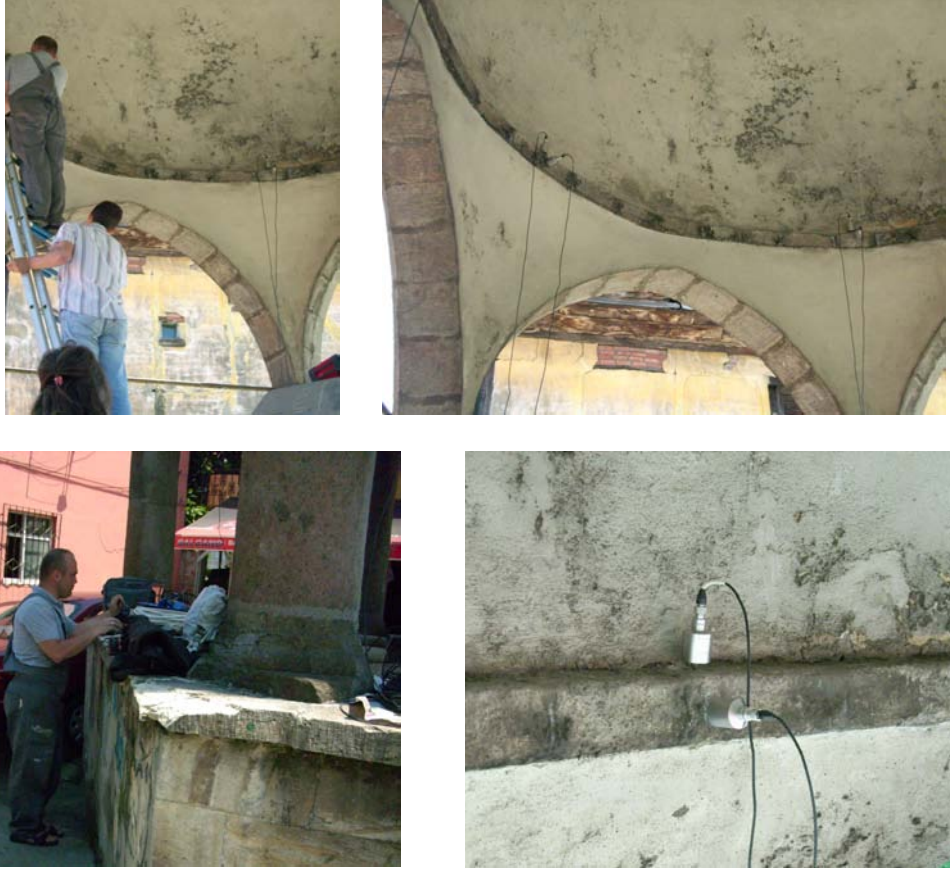
Şekil 2.16. Kavak Meydan Şadırvanı'nda gerçekleştirilen deneysel ölçüme ait görüntüler
