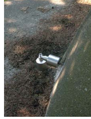
Şekil 2.10. Hamza Paşa Türbesi'nin kubbesi üzerine yerleştirilen ivmeölçerlere ait görüntüler
