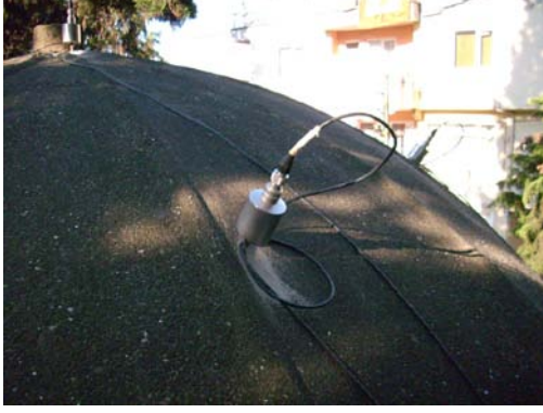
Şekil 2.10. Hamza Paşa Türbesi'nin kubbesi üzerine yerleştirilen ivmeölçerlere ait görüntüler
