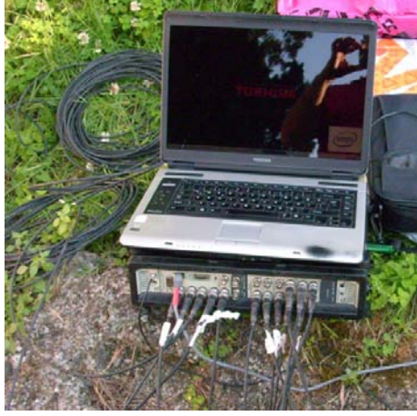
Şekil 1.54. Tipi B&K3560 olan 17 kanallı veri toplama ünitesi ve bilgisayar ortamı
