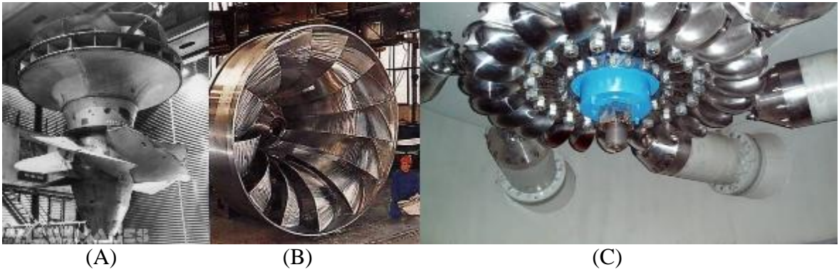
Şekil 1.12. A-Kaplan tip, B-Francis tipi C-Pelton tipi türbin
