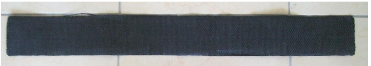
Şekil 2.8. Deneylerde kullanılan 100 x 900 mm boyutlarında kesilmiş örgülü geotekstil
