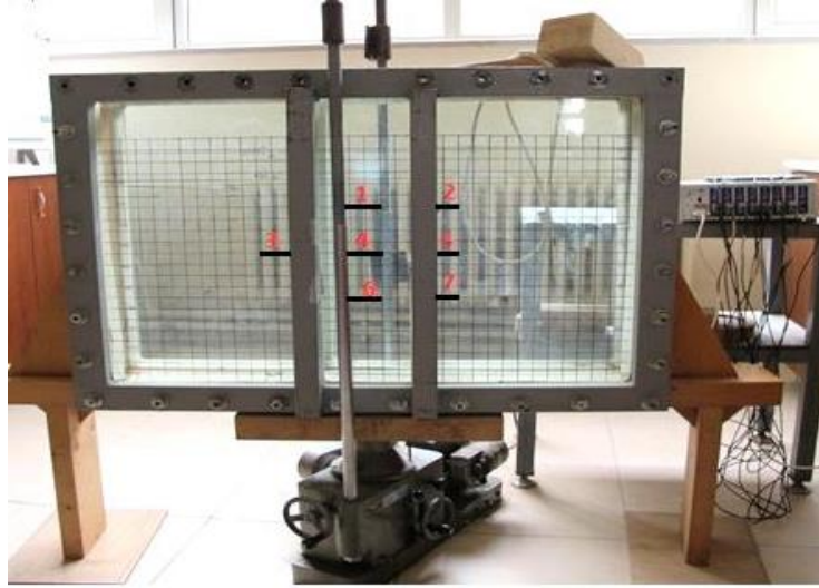
Şekil 3.1. Deney tankında basınç ölçerlerin yerleştirildiği yerler
