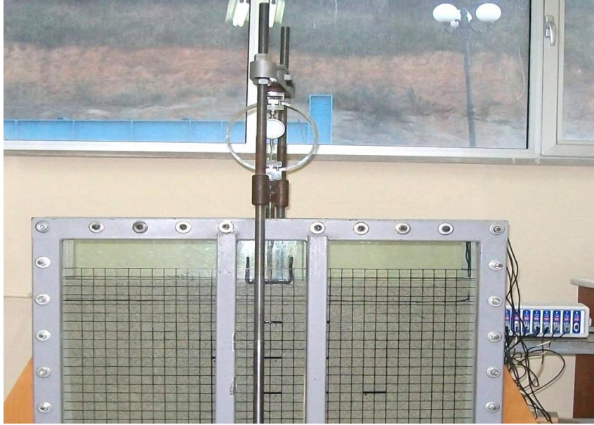
Şekil 2.15. Model şerit temelle donatılı zeminde yapılan bir deneyde yüklemenin başlangıç hali
