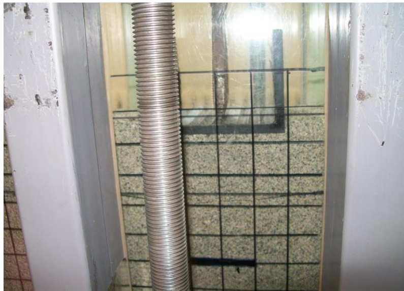
Şekil 2.16. Model şerit temelle donatılı zeminde yapılan bir deneyde yüklemenin bitiş hali
