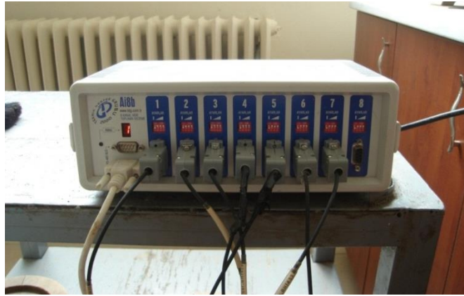
Şekil 2.17. TDG firmasının Ai8b model numaralı veri toplama ünitesi.
