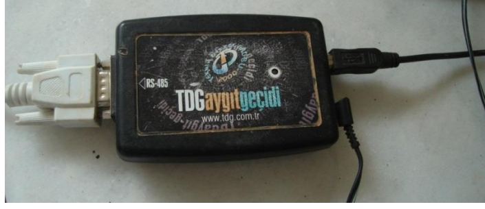
Şekil 2.18. TDG firmasının RS-485 model numaralı aygıt geçidi
