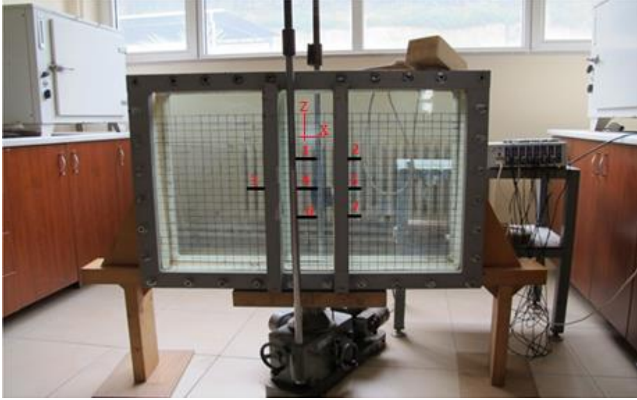
Şekil 3.1. Deney tankında basınç ölçerlerin yerleştirildiği yerler
