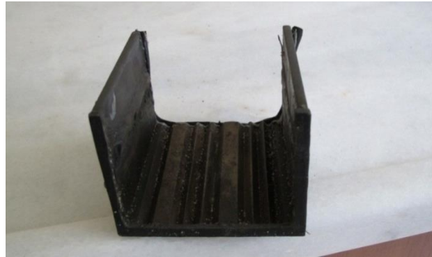
Şekil 2.12. Deneysel çalışmalarda kullanılan model şerit temel
