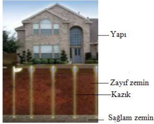
Şekil 1.120. Kazıklı temele sahip yapı [4].
