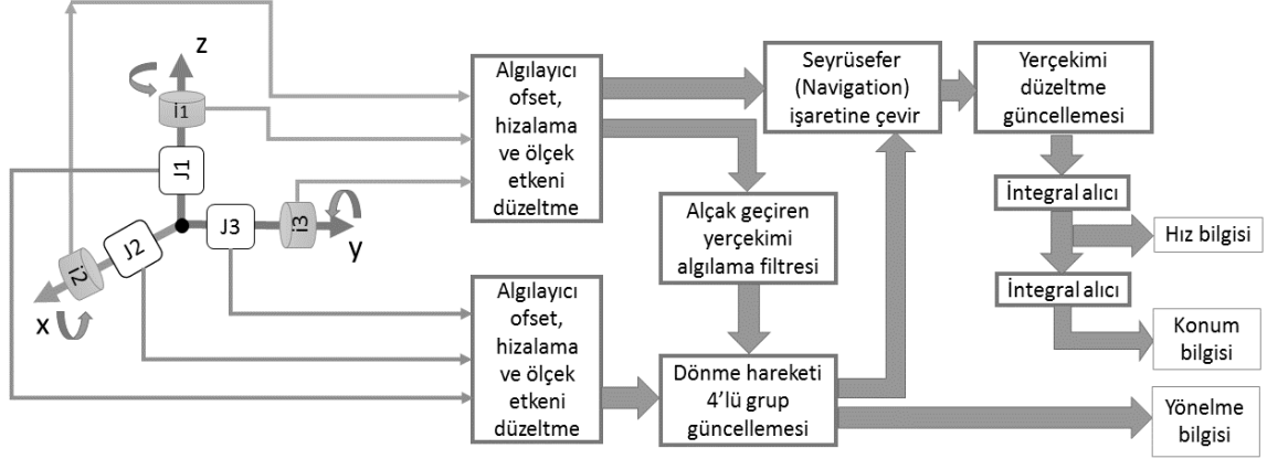
Şekil 1.6. AÖB'den hız, konum ve yönelme bilgisi elde edilmesini gösteren blok diyagram
