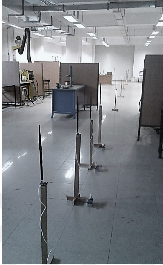
Şekil 2.15. Yol zayıflatma etkeninin izlenmesi amacıyla gerçekleştirilen düzenek ve deney ortamı
