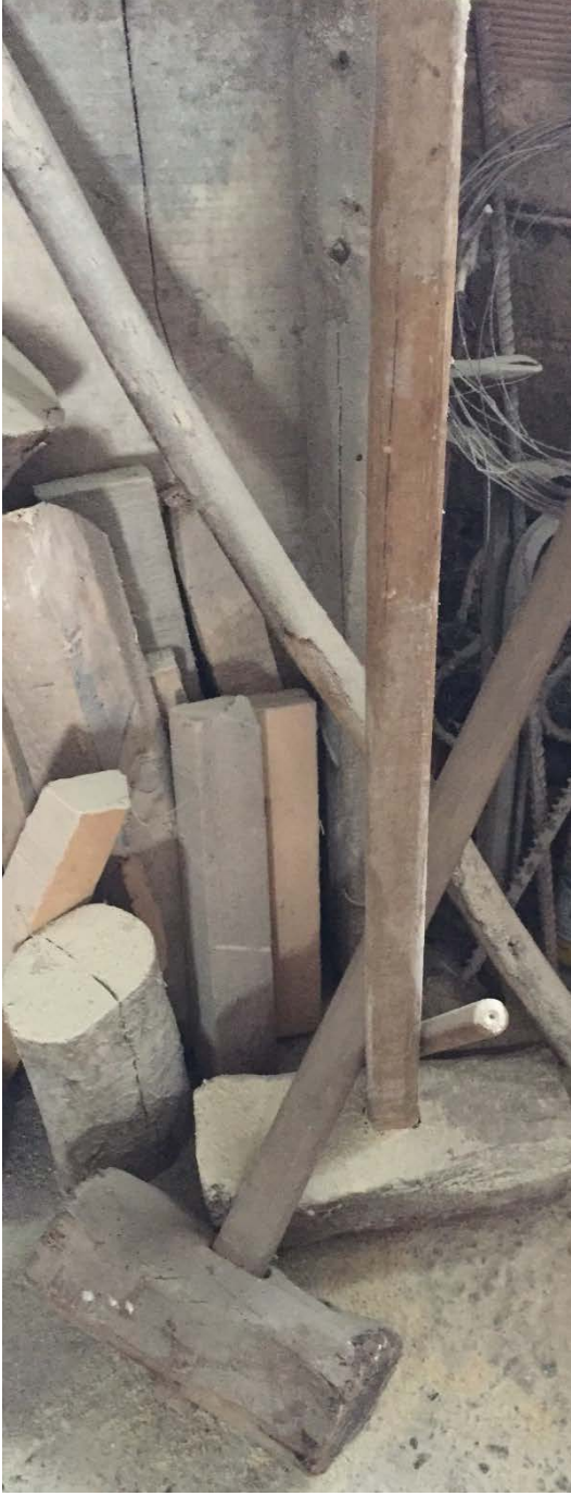
Fotoğraf 104: Tokmak (Kazık Çakmak Amacıyla Kullanılır). Fotoğraf 105: Saç.
