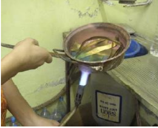
Fot.63: Hasır Örgünün Zaç Yağında Temizlenmesi ve Şaloma ile Tavlanması
