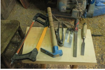
Fot.277: Kemençe Yapımında Kullanılan Aletler
