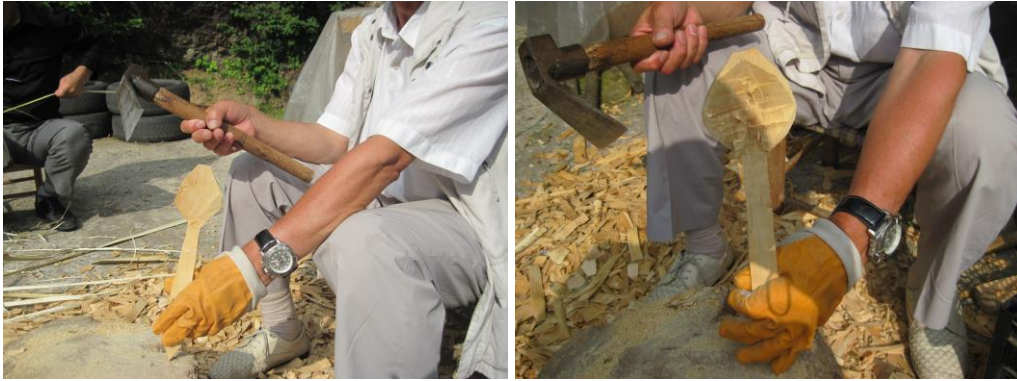
Fot.264: Kaşığın Yapım Aşamaları: Şimşirin Kaşık Modeline Getirilişi ve Yontulması
