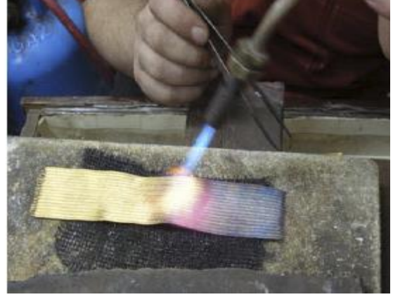
Fot.63: Hasır Örgünün Zaç Yağında Temizlenmesi ve Şaloma ile Tavlanması
