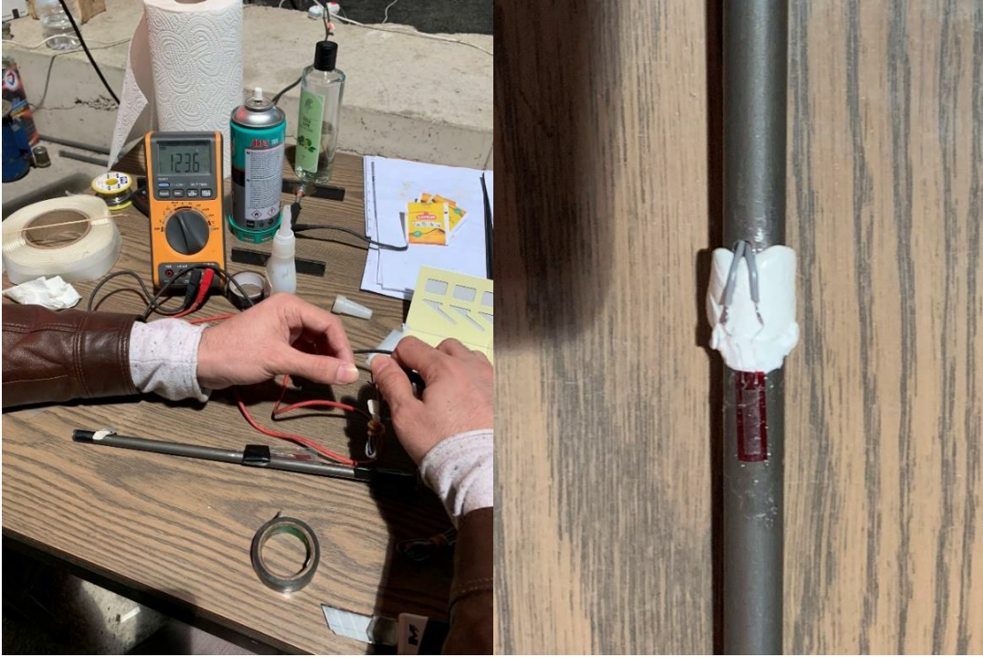
Şekil 2.12. Şekil deęiřtirme ölçerlerin montajı
