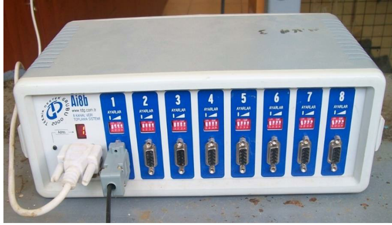
Şekil 2.13 TDG firmasının Ai8b model numaralı veri toplama ünitesi
