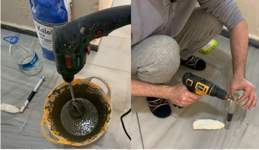
Şekil 2.3. Model kazık imalatı
