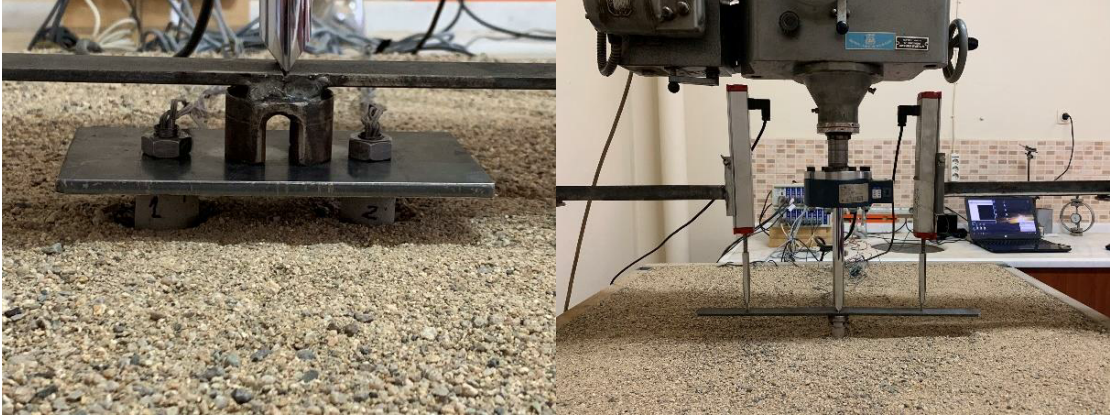
Şekil 3.16. Tek kazık ve iki kazığın aksenal olarak yüklenmesi
