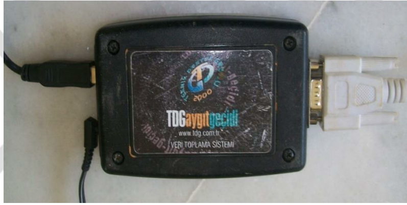
Şekil 2.14. TDG firmasının RS-485 model numaralı aygıt geçidi
