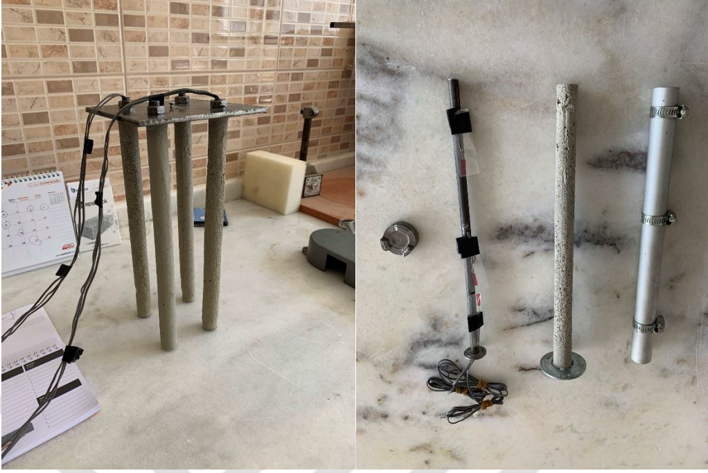
Şekil 2.29. Şekil deęiřtirme ölçerlerin baęlandıęı model kazıklar
