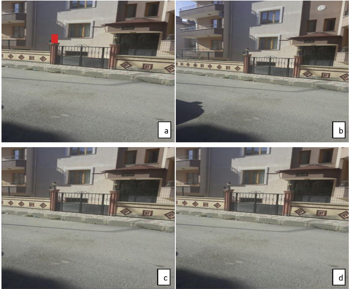
Şekil 1.84. Yerel öznitelik çıkarımı ile görüntü içboyama yöntemi: a) Hasarlı görüntü, (b) İlgili görüntü, (c) SURF özniteliği kullanılarak içboyama yapılmış görüntü, d) Özgün görüntü.
