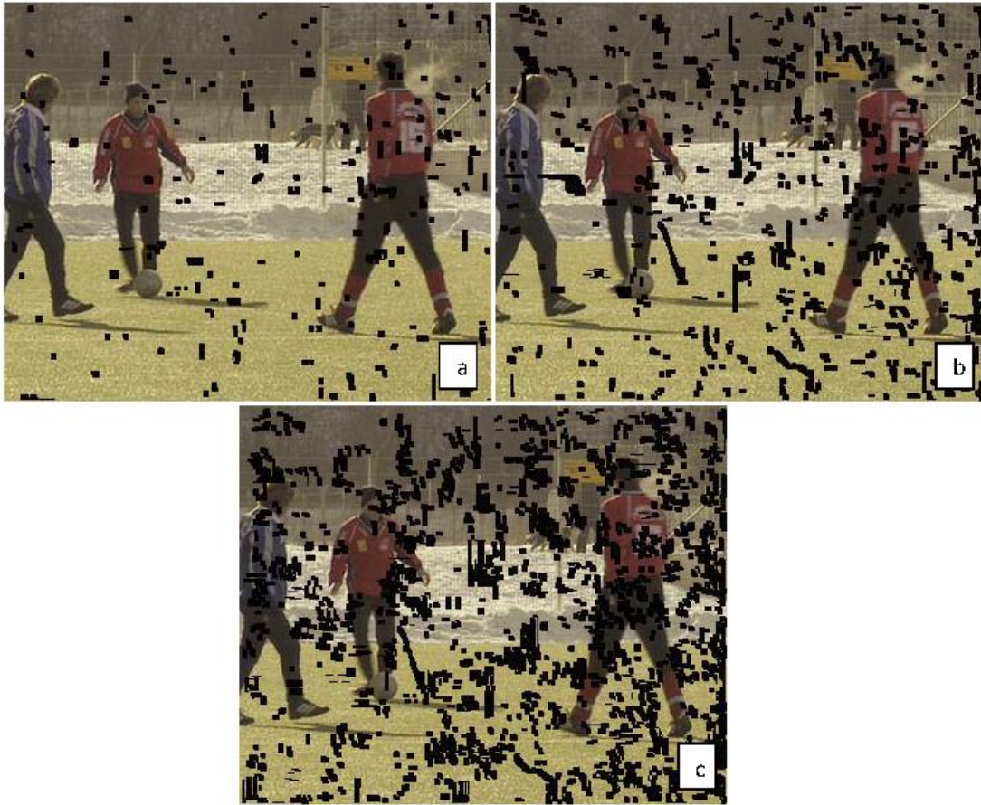
Şekil 1.58. Performans karşılaştırması için kullanılan siyah yapay lekeler eklenmiş 'futbol' hareketli görüntü dizisi: a) Piksel sayısının %5'i kadar lekeye sahip film karesi b) Piksel sayısının %15'i kadar lekeye sahip film karesi ve c) Piksel sayısının %30'u kadar lekeye sahip film karesi
