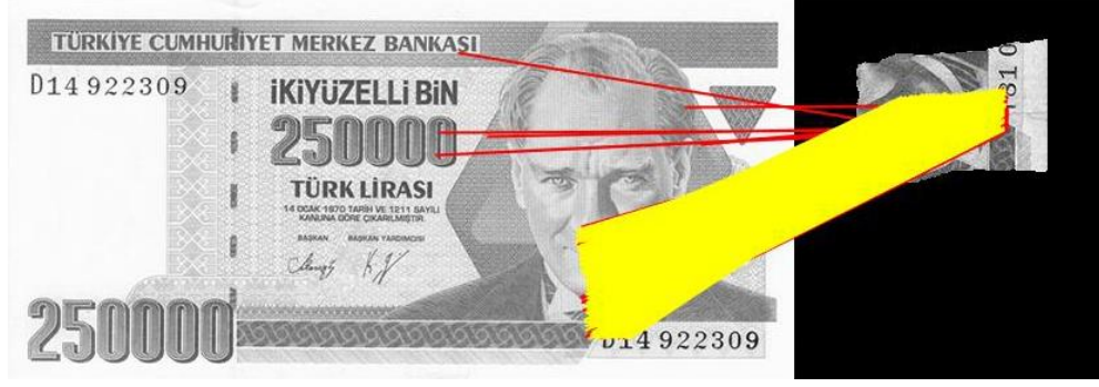
Şekil 3.8. Zernike momentte yineleme sayısı 15 yapılarak bir parçanın referans görüntü ile eşleştirilmesi
