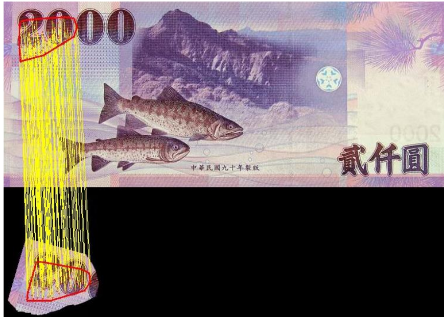
Şekil 2.16. Referans banknot ile parça arasında doğru eşleşen anahtar noktalara minimum kapalı çevrimin uygulanması
