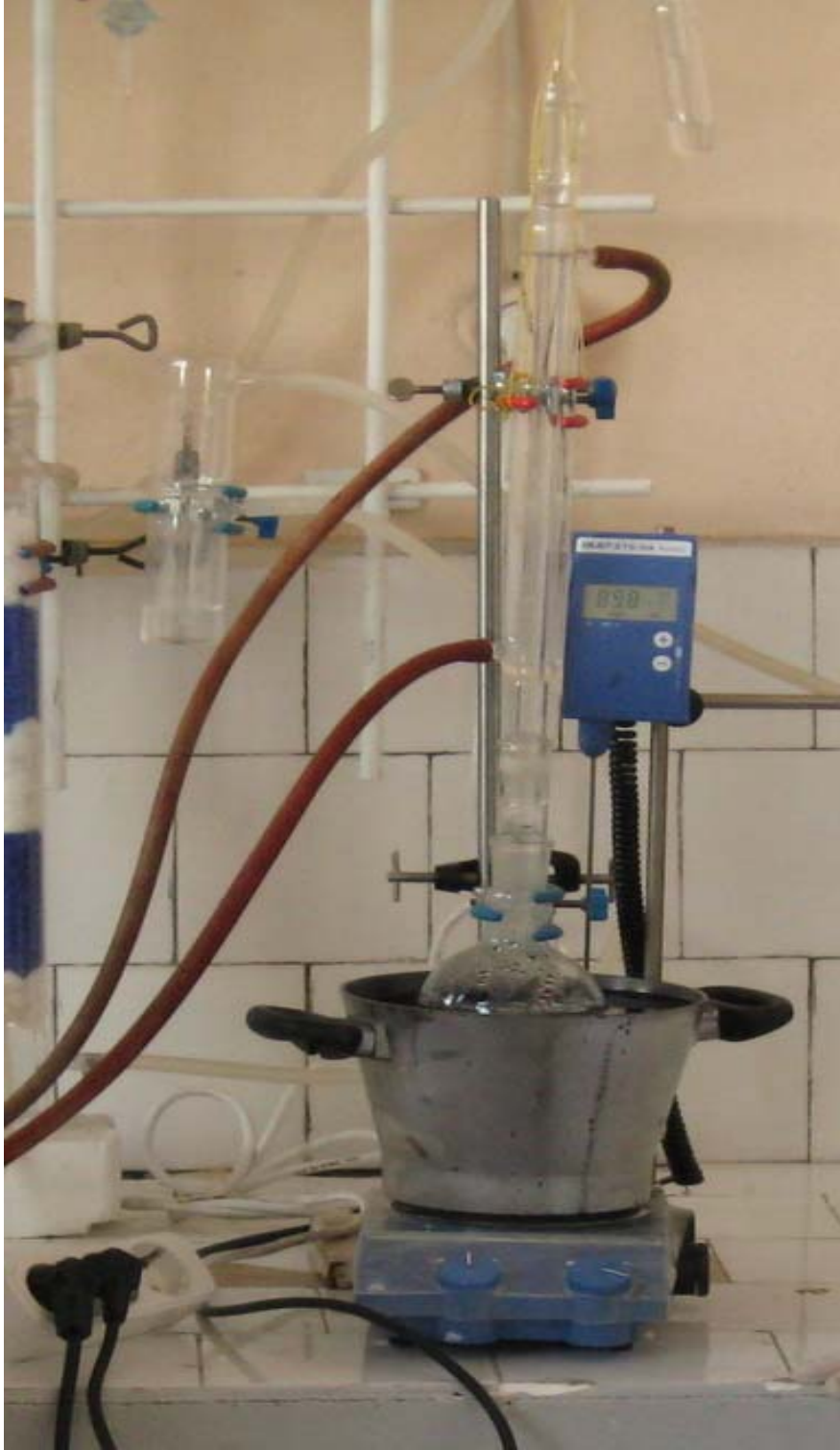
Şekil 15. PMSQ sentezi için kurulan deney düzeneği
