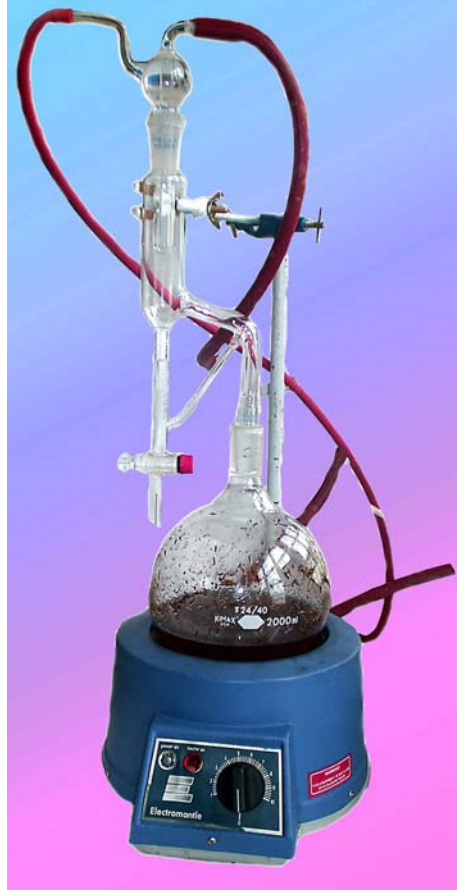
Şekil 2. Clevenger tipi subuharı destilasyon düzeneği
