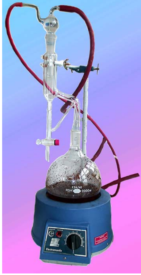
Şekil 2. Clevenger tipi subuharı destilasyon düzeneđi
