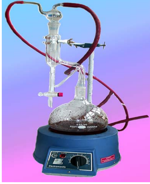
Şekil 6. Clevenger ipi su buharı düzeneđi
