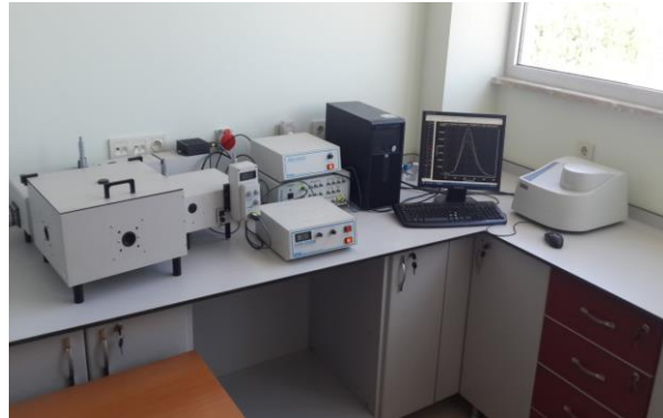
Şekil 11. Kullanılan QM-4-2006 PTI spektrofiorimetre cihazı
