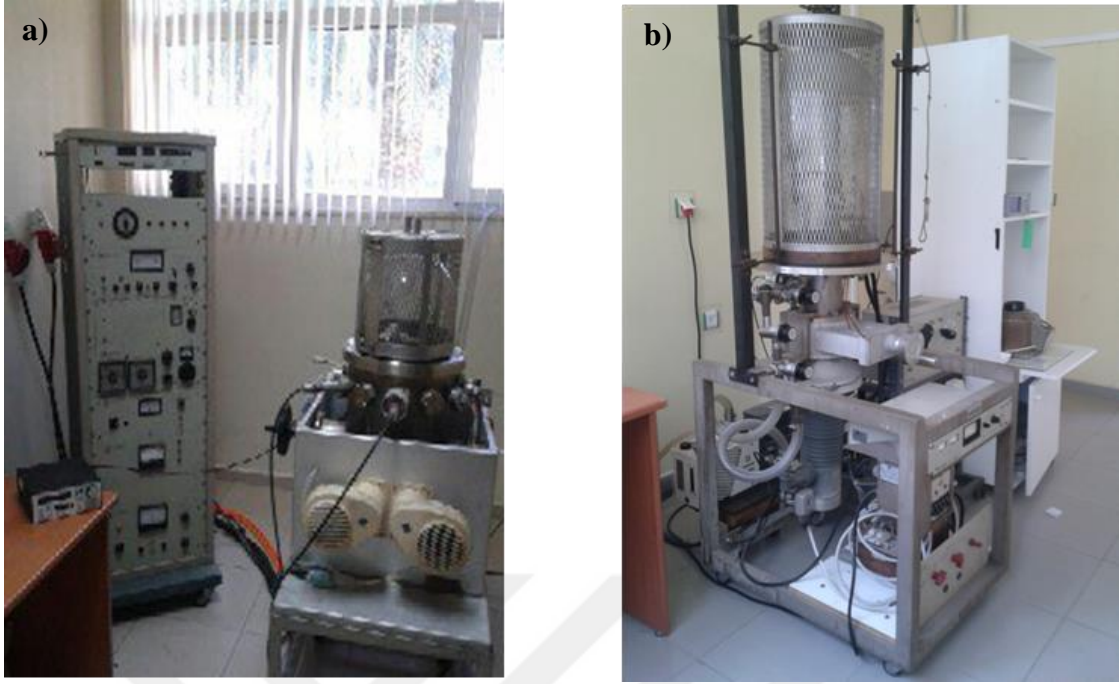
Şekil 2. 2. (a) Elektron demeti ile buharlaştırma sistemi ve (b) Varian NRC 840 termal buharlaştırma sistemi
