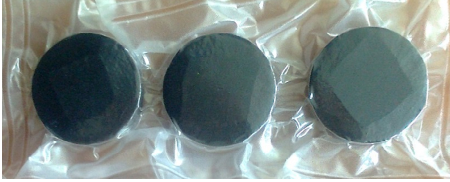
Şekil 2. 2. Çalışmada kullanılan silindirik YBCO külçe süperiletkenler
