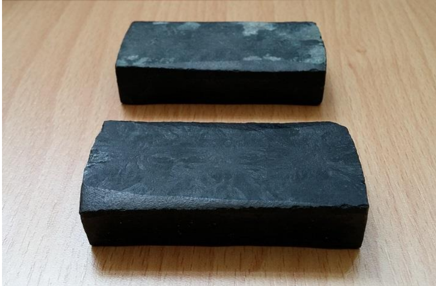
Şekil 2.4. Çalışmada kullanılan üç tohumlu YBCO süperiletkenleri
