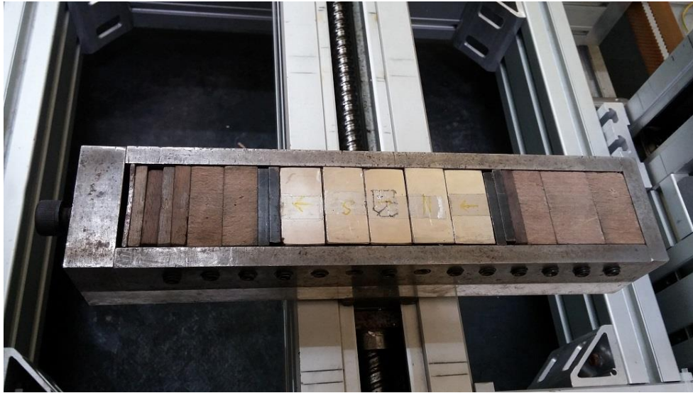
Şekil 2.6. Farklı manyetik alan yönelimlerine sahip mıknatıslardan oluşan örnek bir PMG dizilimi
