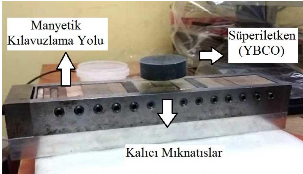
Şekil 1.11. Süperiletken YBCO malzemenin manyetik kılavuzlama yolu üzerinde temassız olarak havada durması (Fotoğraf KTÜ araştırma laboratuvarında alınmıştır)
