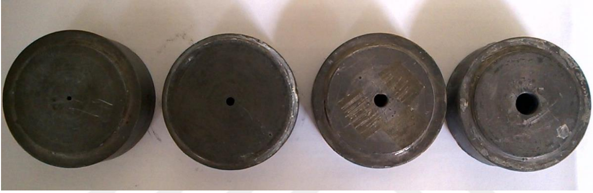
Şekil 2.4. Farklı çaplardaki kurşun kolimatörler
