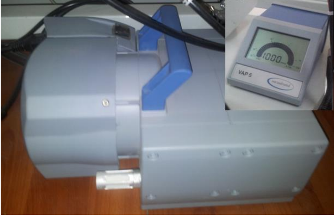
Şekil 2.11. Vakum pompası ve göstergesi
