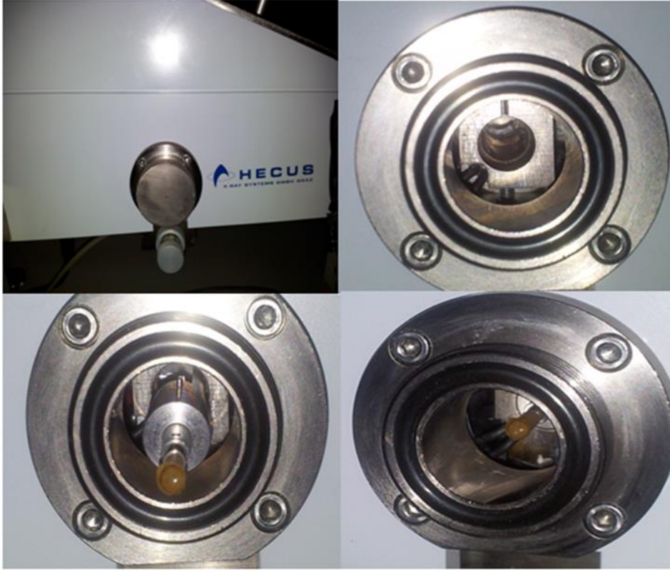
Şekil 2.7. Örnek bloğu ve örnek tutucunun yerleştirilmesi
