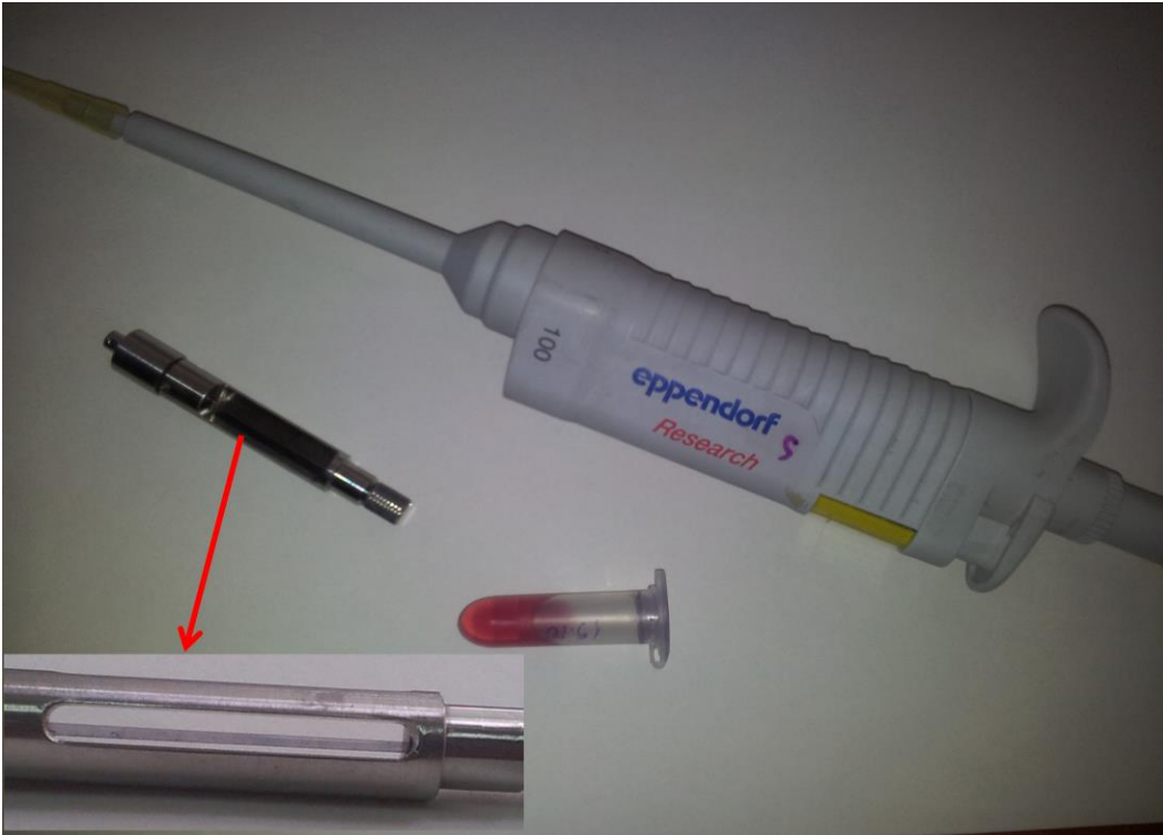
Şekil 2.8. Sıvı örnek tutucu ve örneğin ölçüm için hazırlanması
