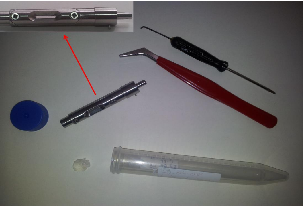
Şekil 2.10. Örümcek ağları ince filmler gibi kalınlığı az olan örneklerin ölçüm için hazırlanması
