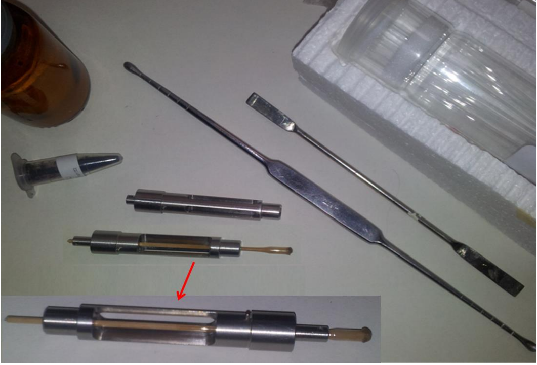
Şekil 2.9. Toz örneklerin ölçümü için örnek ve örnek tutucunun hazırlanması
