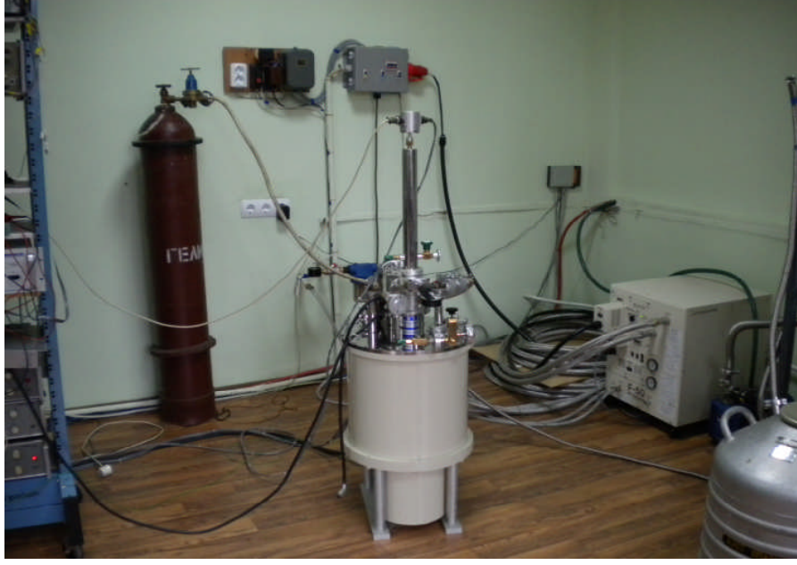
Şekil 2.12. 8T süperiletken selonoidli Sumitomo F-50 kapalı döngü ^4\text{He} soğutucusu
