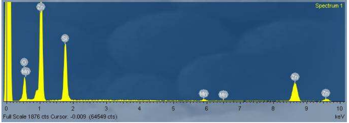
Şekil 3.11. 600 °C’de 8 saat tavlanan Mn katkılı ZnO nanoçubukların EDS spektrumu
