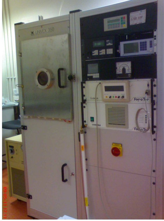
Şekil 2.4. Kuartz kristal monitörü içeren elektron demetli buharlaştırma sistemi
