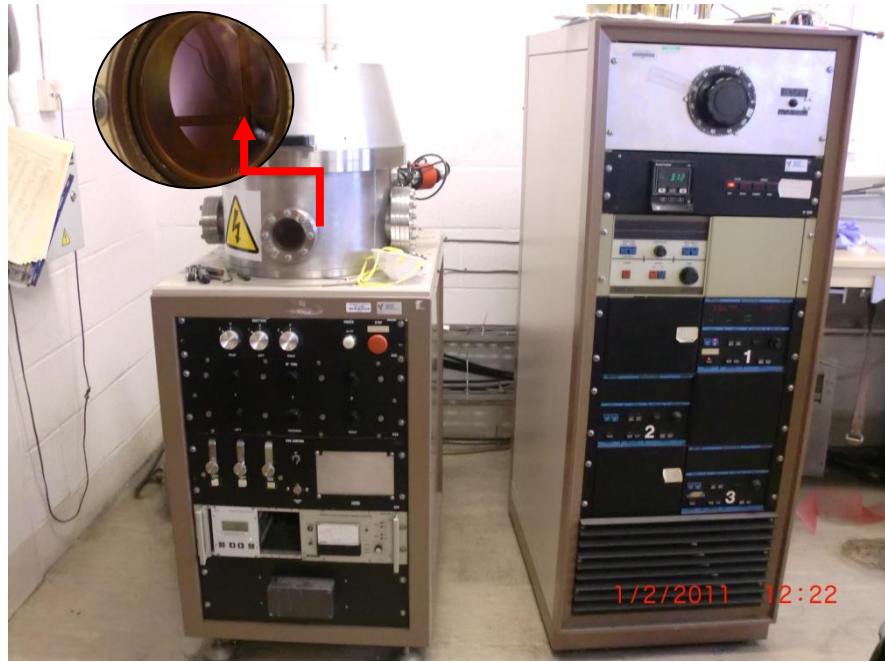
Şekil 13. Sputtering (Püskürtme) cihazı ve görünen Argon Plasma (HTS Laboratuvarı, Oxford Üniversitesi)
