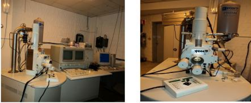
Şekil 36. SEM-EDX, JEOL-6300 (Antwerp Üniversitesi)
