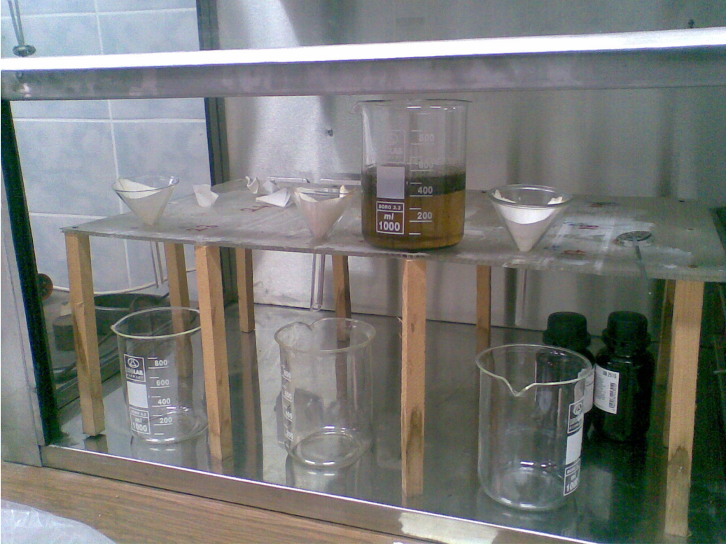
Şekil 15. Gravimetrik ayırma işleminde kullanılan deney düzeneği
